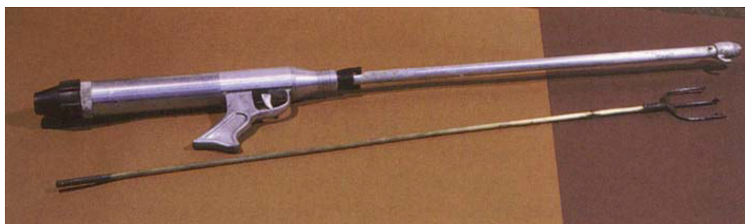
Slika 12. Podvodna puška na komprimirani zrak Kit 61. [15]
