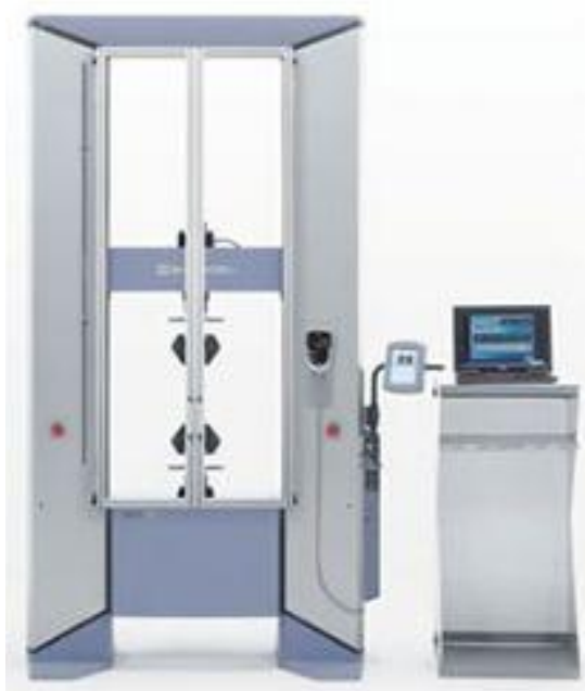
Slika 31. Kidalica Shimadzu AG-Xplus [40]
