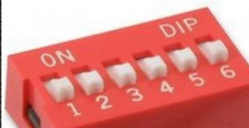
Slika 57. Logička kombinacija za odabir jačine struje
