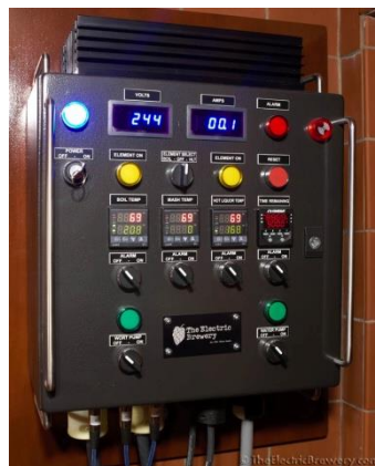
Slika 79. Primjer upotrebe LED indikatora
