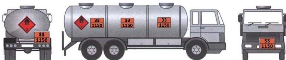
Slika 19. Označavanje vozila za prijevoz etilen diklorida
