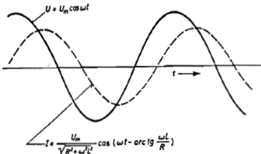
**Slika 16.** Dijagram vektorskog slijeda oscilacija jakosti struje i napona u krugu s otporom  $R$  i zavojnicom induktivnosti  $L$
