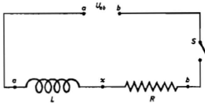
**Slika 11.** Mehanizam pohranjivanja elektromagnetske energije u zavojnici
