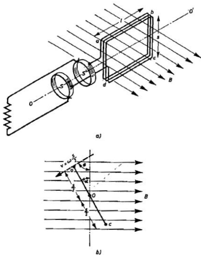
**Slika 7.** Princip rada rotacijskog generatora elektromotorne sile
