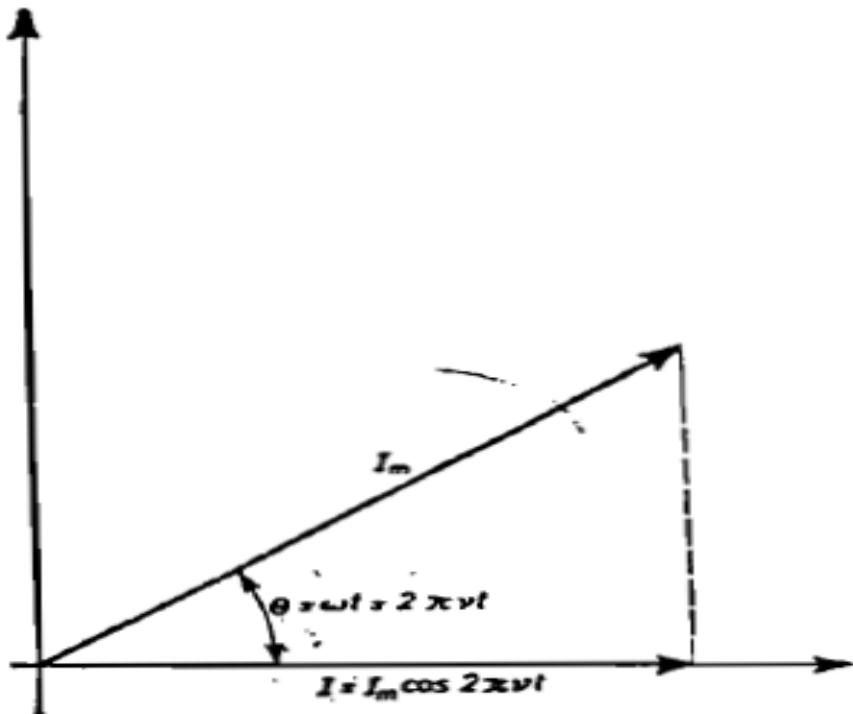
**Slika 23.** Prikaz izmjenične struje pomoću metode rotirajućih vektora
