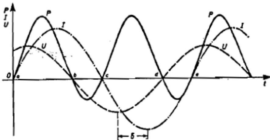
**Slika 28.** Vremenska promjena snage izmjjenične struje u ovisnosti o vremenskoj promjeni jakosti struje i napona
