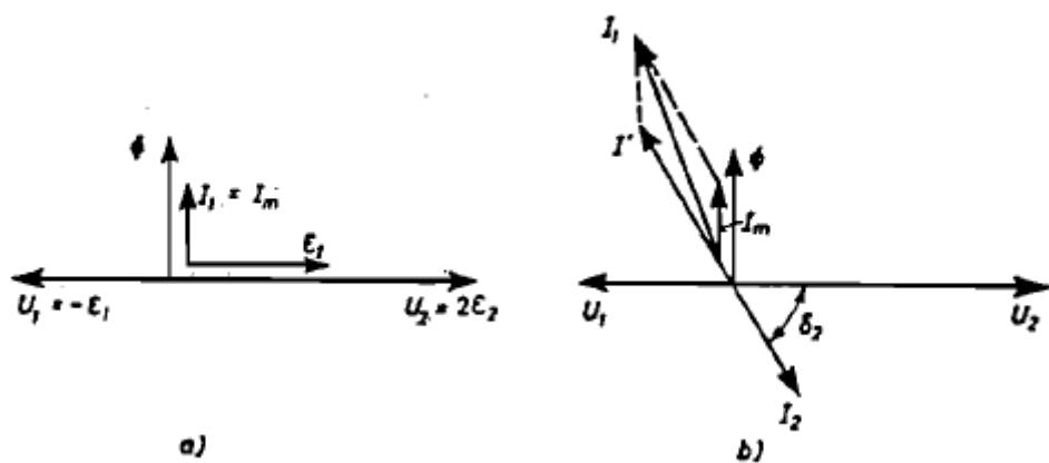
**Slika 34.** Vektorski dijagrami jakosti struje i napona u transformatoru za slučaj  $\frac{N_2}{N_1} = 2$ : a) sekundar je otvoren  $I_2 = 0, I_1 = I_m$ ; b) U sekundarni krug je uključen potrošač s induktivnim otporom
