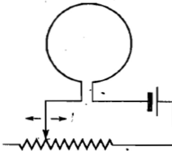
**Slika 8.** Promjene toka kroz petlju kojom teče promjenjiva struja izazivaju samoindukciju u petlji
