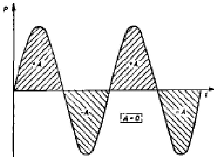
**Slika 31.** Električni rad pri induktivnom ili kapacitivnom opterećenju
