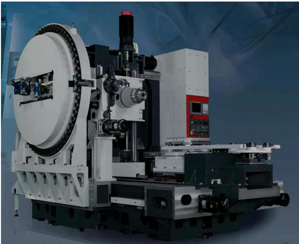
Slika 4. Horizontalni glodači obradni centar
