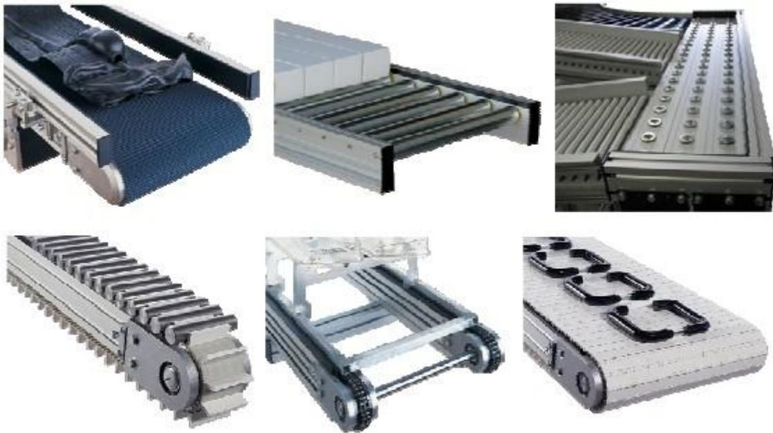
Slika 23. Različiti prijenosni elementi konvejera: a) trake, b) valjci, c) kuglični elementi, d) klinasti remen, e) lanci, f) plastični elementi
