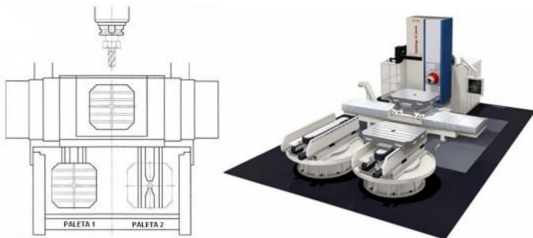
Slika 27. Izmjena paleta s dva manipulacijska stola
