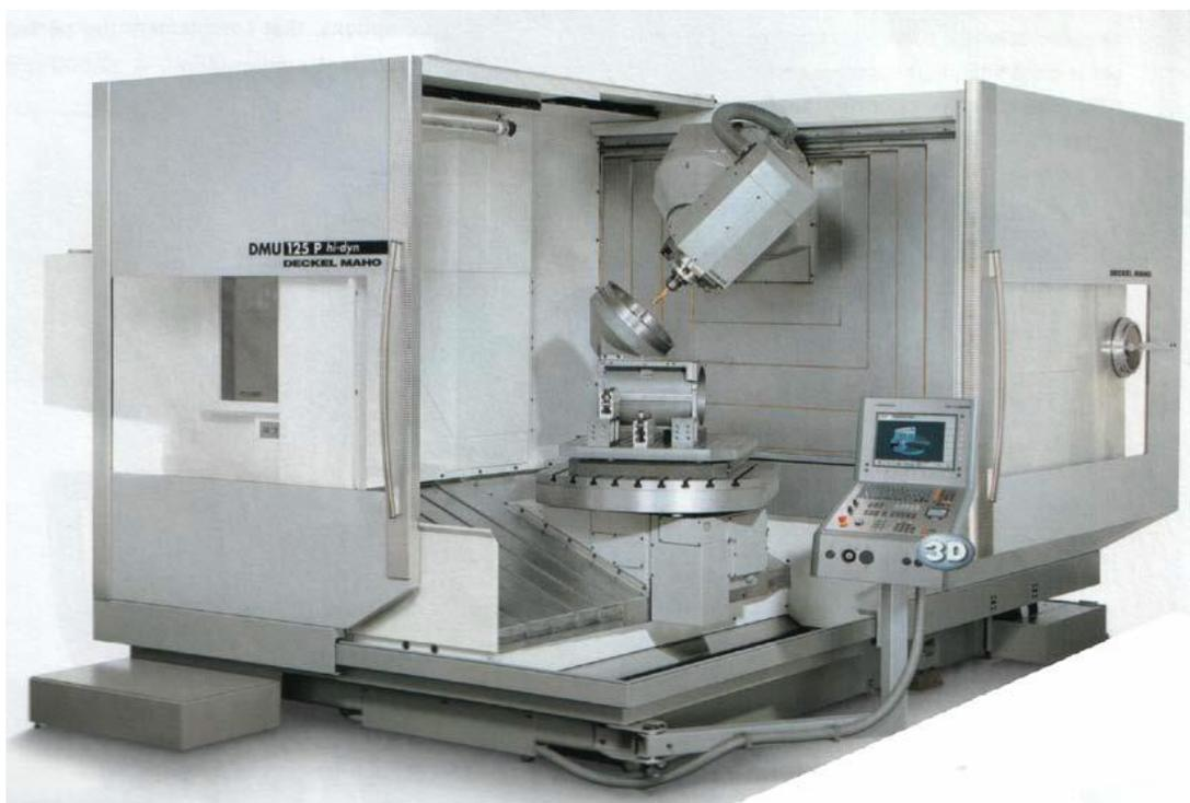
Slika 6. Horizontalno/vertikalni glodači obradni centar
