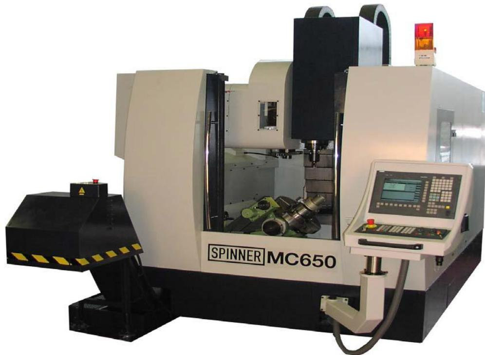
Slika 5. Vertikalni glodači obradni centar
