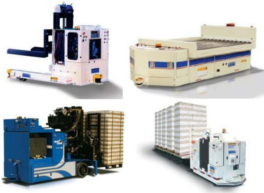
Slika 24. AGV-ovi različitih namjena: a) prijevoz namotaja, b) izvedba s konvejerom, c) viljuškar, d) vuča tereta
