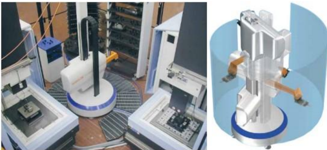
Slika 30. Manipulator za izmjenu paleta između više obradnih strojeva
