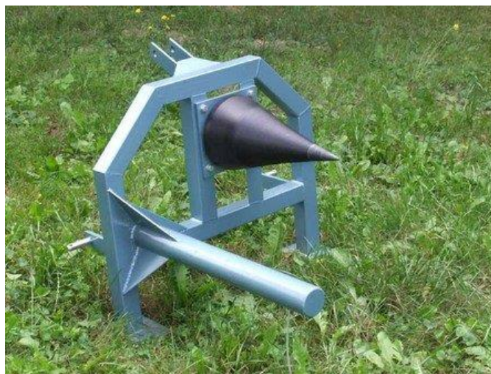
Slika 7. Cjepač za drva sa svrdlom. [6]
