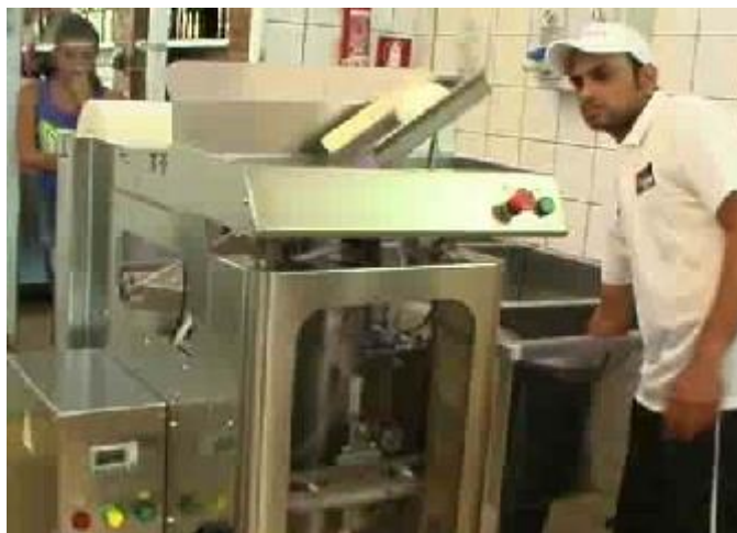
Slika 8. Automatska zaštita onemogućuje zaposleniku pristup u opasnu zonu tijekom rada stroja [16.]
