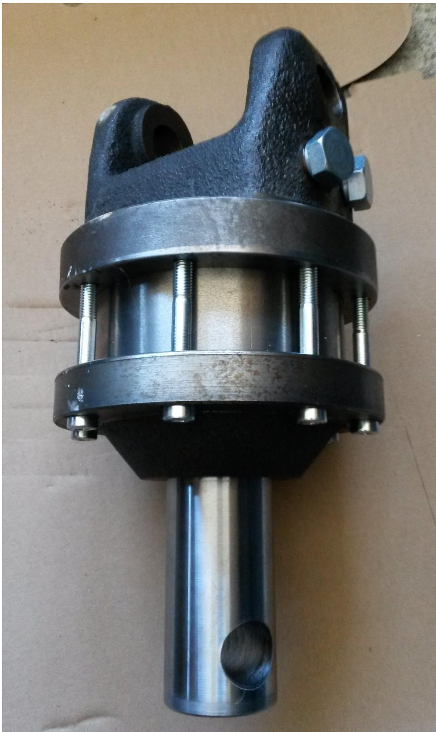
Slika 28. Stvarni izgled hidrauličkog motora
