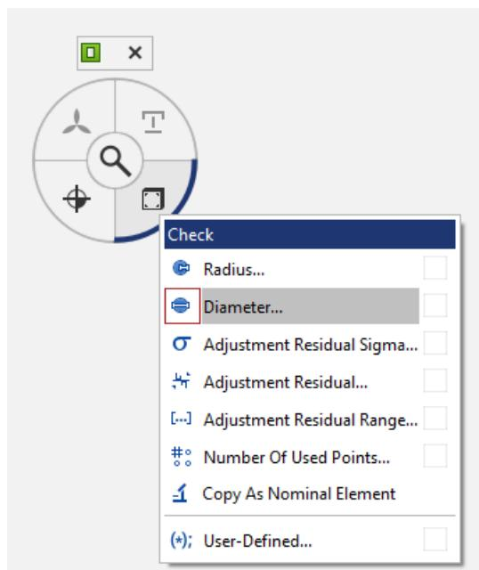
Slika 27. Naredba za izmjjeru promjera cilinda
