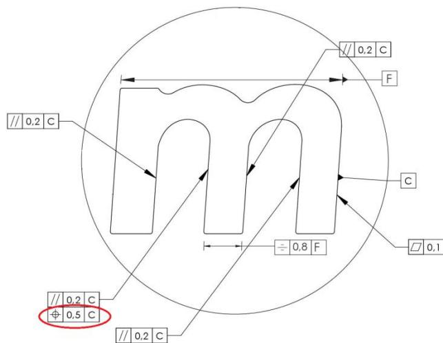
Slika 60. Prikaz površine na kojoj će se vršiti kontrola položaja
