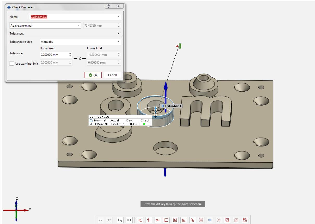
Slika 45. Usporedba vrijednosti CAD i stvarnog modela
