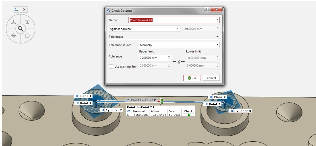
Slika 51. Rezultati mjerjenja udaljenosti između dva cilindra
