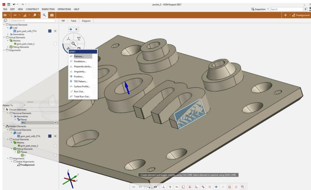
Slika 53. Ispitivanje ravnosti
