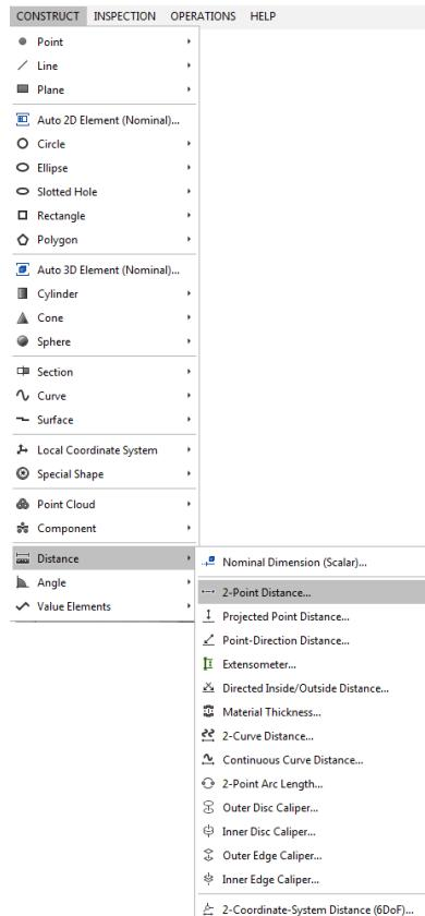
Slika 49. Naredba za konstrukciju udaljenosti između dvije točke
