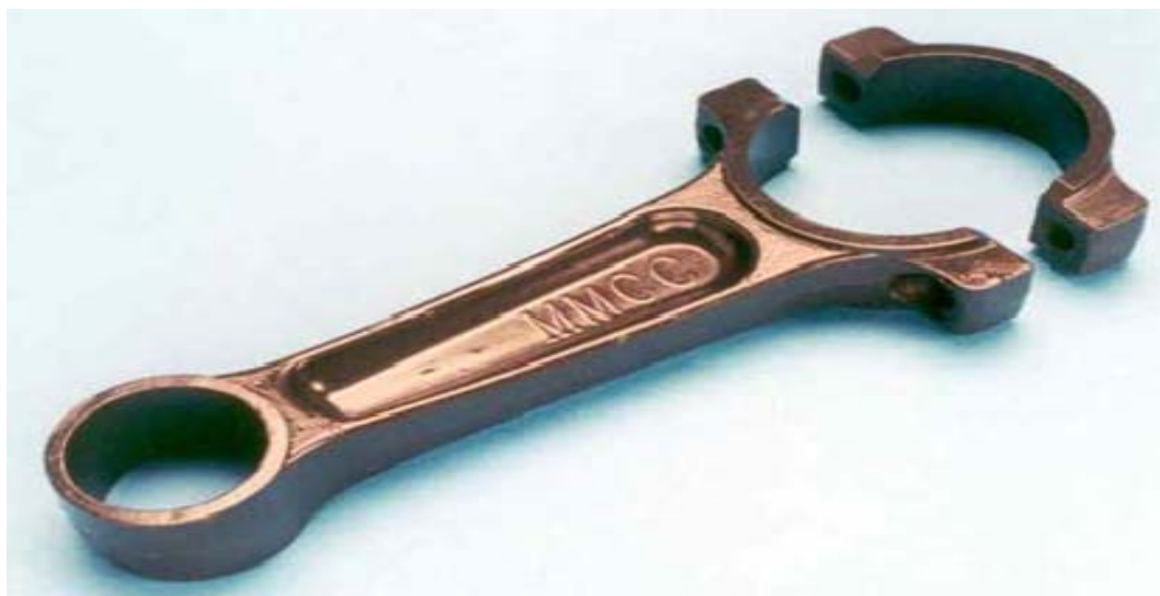
Slika 33. Klipnjača od Al-legure ojačane s Al 2 O 3 česticama [19]
