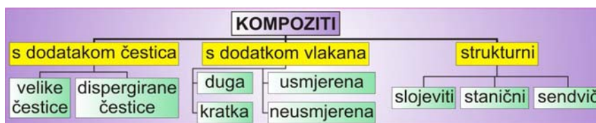
Slika 4.: Prikaz podjele kompozita prema dodatku (ojačalu) [1]
