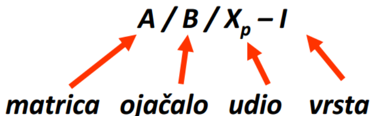
Slika 28. Označivanje metalnog kompozita [11]
