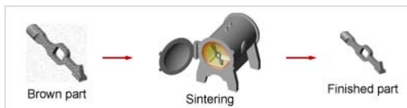
Slika 50. Prikaz procesa sinteriranja [39]
