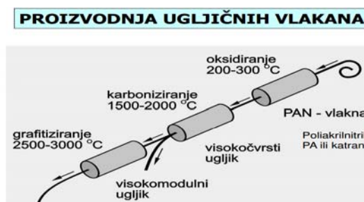
Slika 21: Prikaz postupka proizvodnje vlakana – ugljičnih [9]
