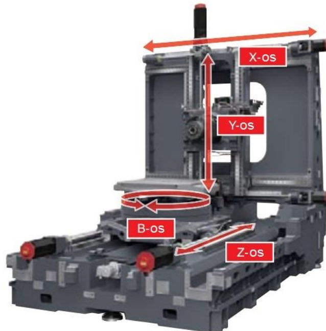
Slika 27 Izvedba horizontalnog glodaćeg obradnog centra [15]
