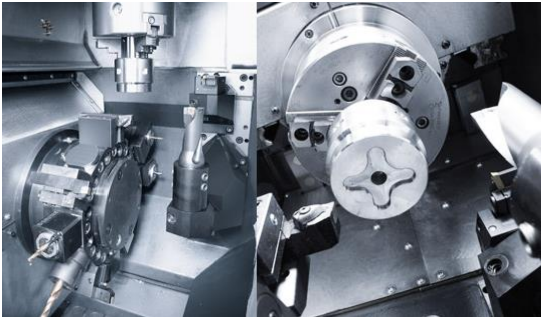
Slika 8 Izvedba proizvodnog vertikalnog tokarskog obradnog centra [7]
