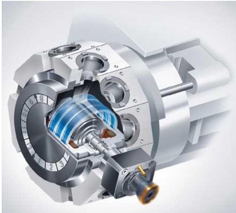
Slika 19 Prikaz pogona reznog alata na revolverskoj glavi [7]
