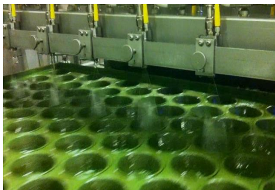
Slika 2. Nauljivanje kalupa / Autor slike 2: Spraying Systems Co.
