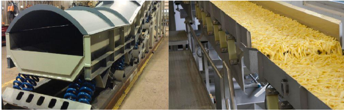
Slika 12. Zatvoreni (obli) i otvoreni (pravokutni) tip konvejera [4]
