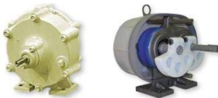
Slika 15. Prikaz pogona posredne i direktne uzbude ekscentritetom [6]
