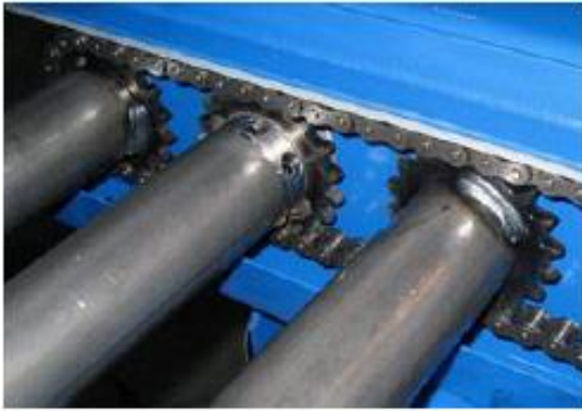
Slika 10. Prijenos vučne sile lancem
