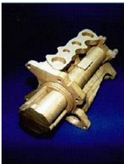
Slika 12. Model bloka motora nastao LOM tehnologijom. [12]
