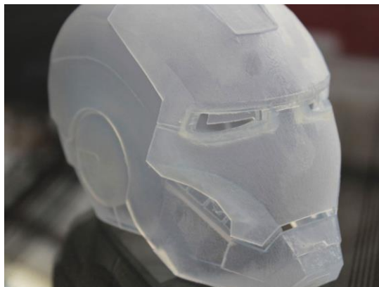
Slika 25. Model izrađen od polikarbonata. [25]
