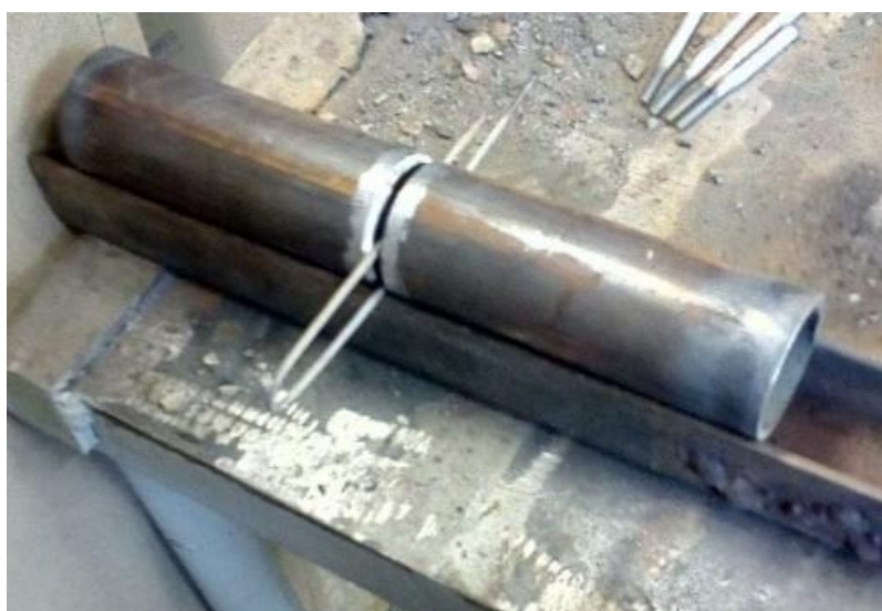
Slika 34. Pripajanje dva komada cijevi
