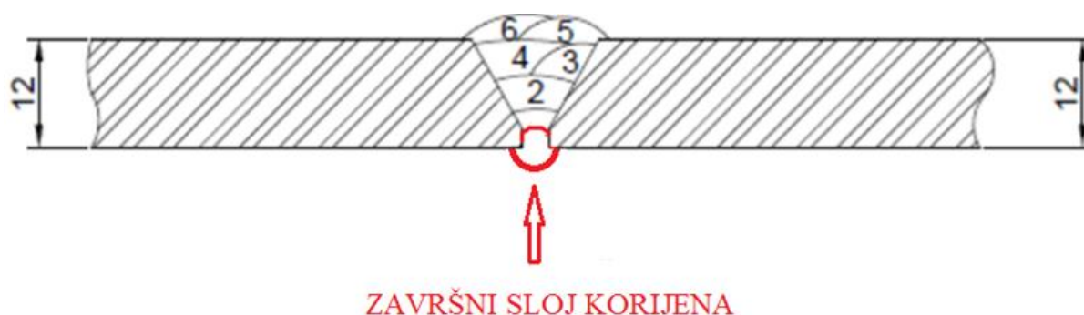
Slika 57. Shematski prikaz završnog zavora nakon brušenja
