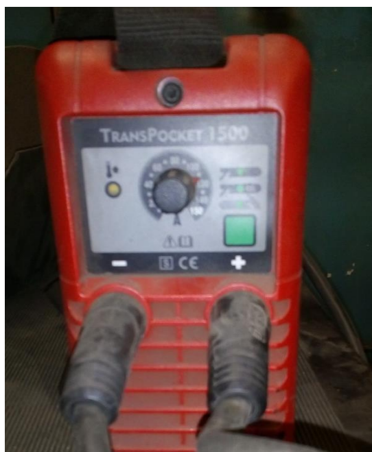
Slika 50. Prijenosni uređaj za ručno elektrolučno zavarivanje
