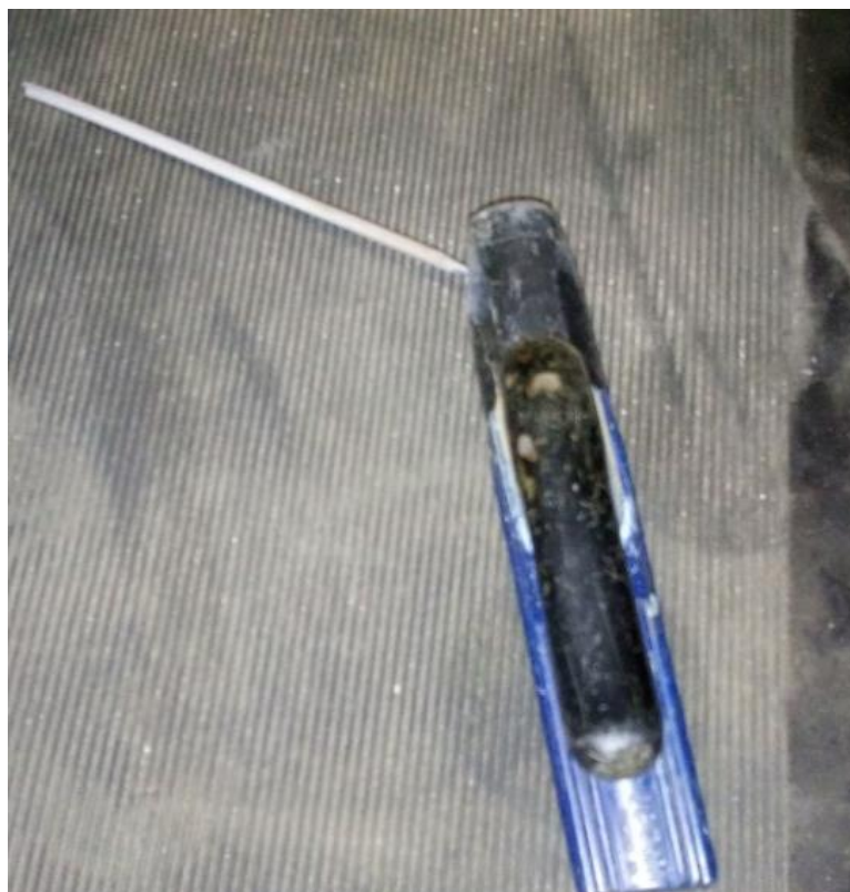
Slika 48. Elektroda u držaču elektode
