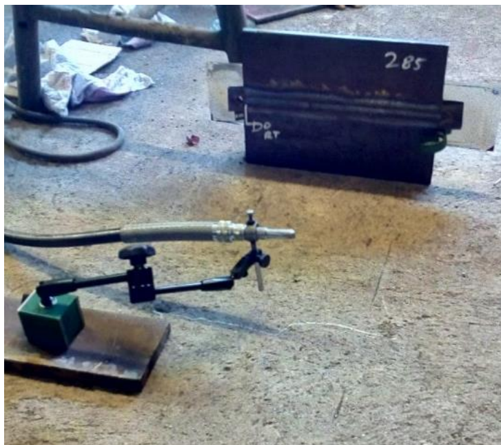
Slika 58. Priprema uzorka za ispitivanje radiografijom
