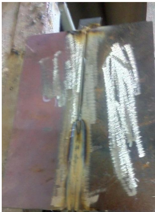
Slika 54. Prekid u završnom sloju
