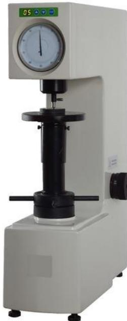
Slika 7.2.1. Uređaj za ispitivanje površinske tvrdoće po metodi Rockwell.
