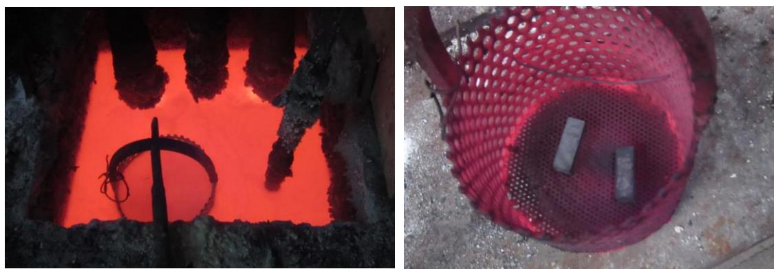
Slika 7.1.5. Kaljenje epruveta.
