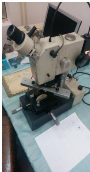
Slika 7.2.2. Mjerni uređaj LEITZ WETZLAR MODEL DURIMET 2.
