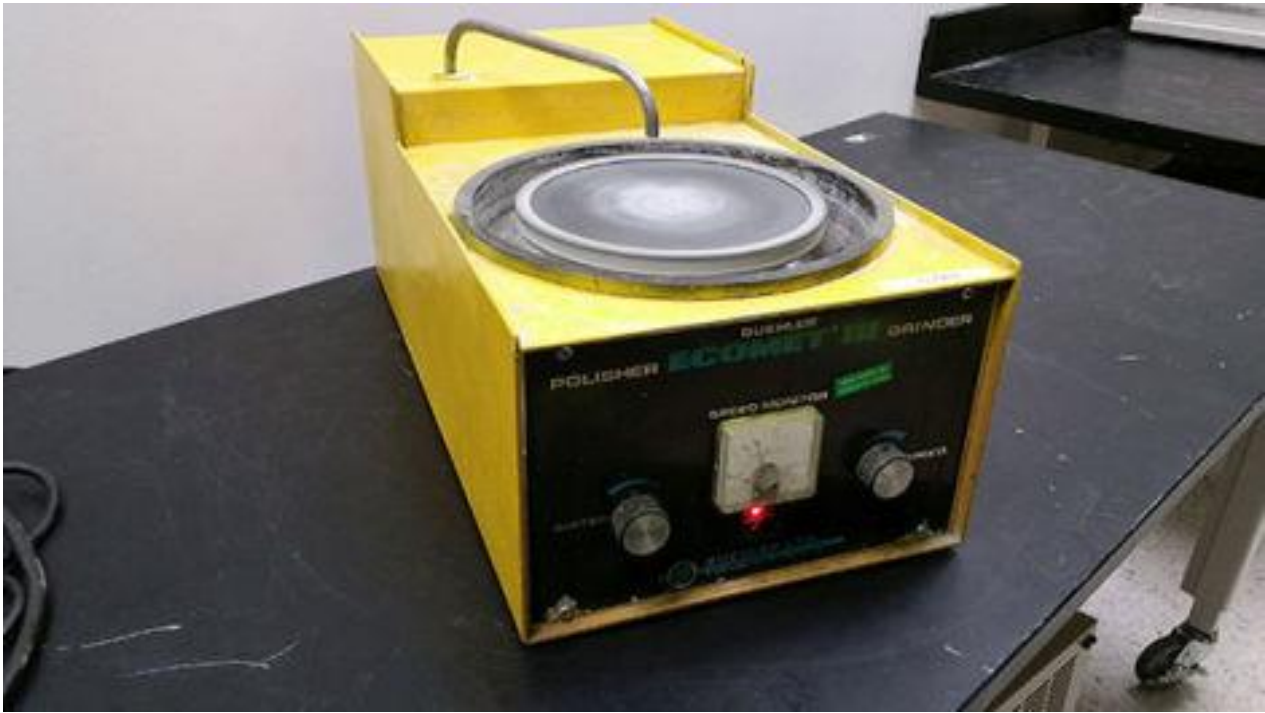
Slika 7.1.9. Polirka BUEHLER ECOMET 3.
