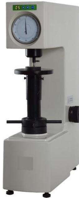
Slika 7.2.1. Uređaj za ispitivanje površinske tvrdoće po metodi Rockwell.
