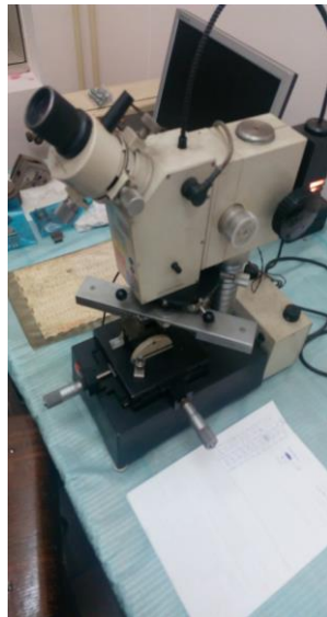
Slika 7.2.2. Mjerni uređaj LEITZ WETZLAR MODEL DURIMET 2.
