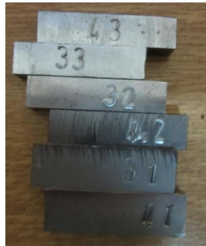
Slika 7.1.1. Pripremljene i označene epruvete.
