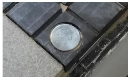
Slika 106. Metalni disk za umjeravanje alata
