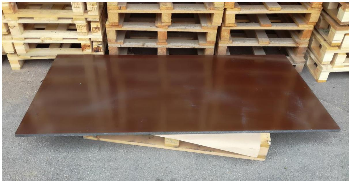
**Slika 55. Sirova bakelitna ploča debljine 20mm dimenzije 2070x1070**
