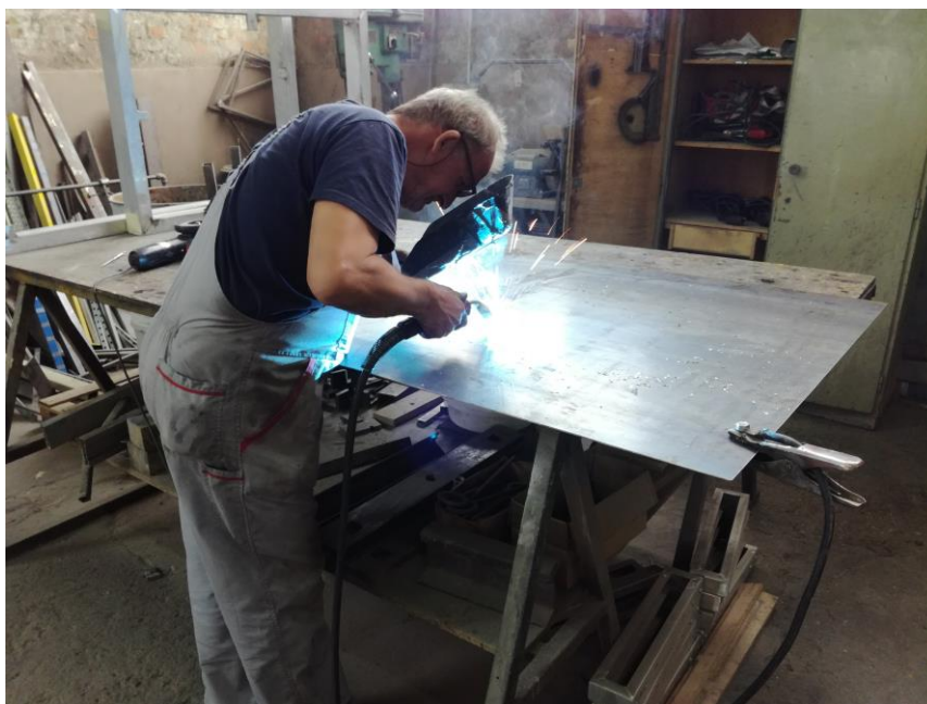
Slika 74. Majstor zavaruje cijev na HV lim
