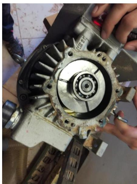
Slika 100. Lamele u vakuum pumpi
