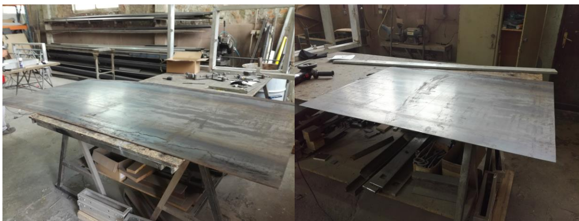
Slika 72. HV limena ploča cijela (lijevo) i okrajčena (desno)
