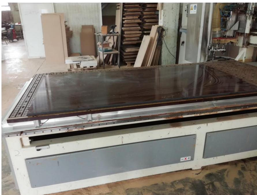
Slika 56. Bakelitna ploča na CNC-u Bulleri u Aquaestil plus d.o.o.
