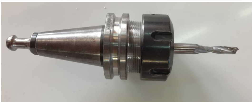
Slika 49. Spiralno dvoperno glodalo promjera 6mm
