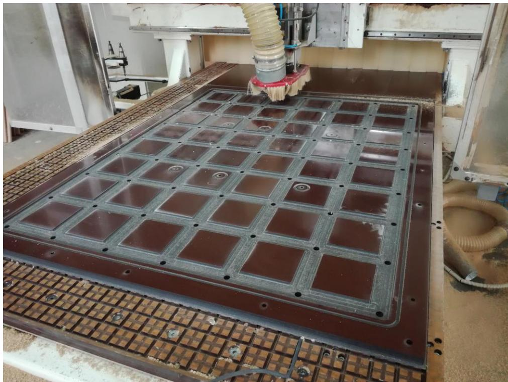
**Slika 60. Bušenje rupa i vanjsko obrezivanje**
