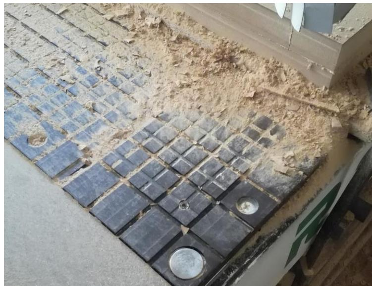
Slika 141. Oštećenje vakuum stola
