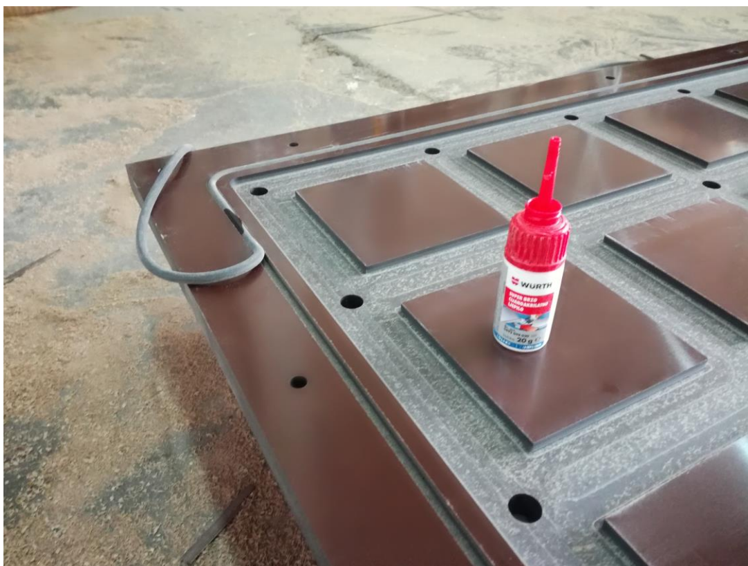
Slika 61. Lijepljenje gumene brtve u komoru vakuum stola
