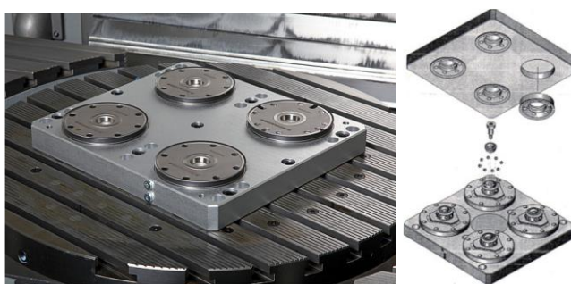
Slika 13. Stezni sustavi s definiranom nultočkom
