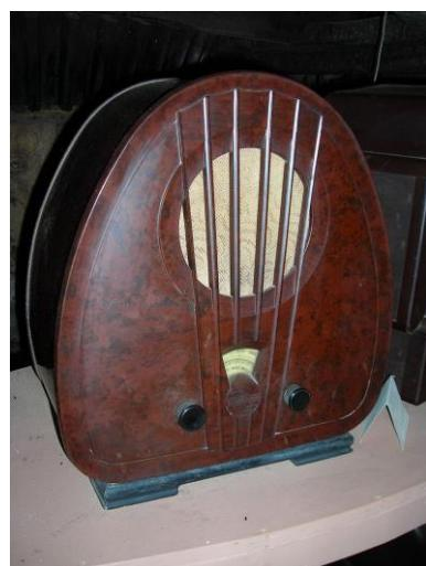
Slika 32. Stari radio s vanjskim bakelitnim kućištem
