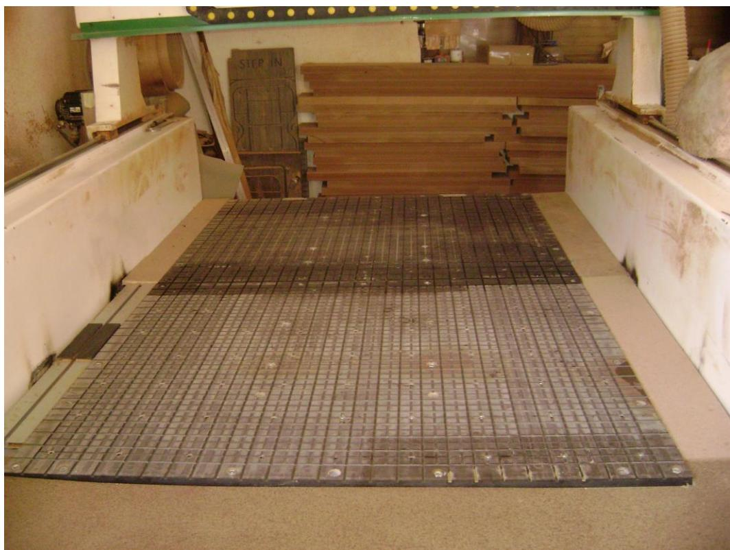
Slika 104. Završen vakuum stol spremam za korištenje
