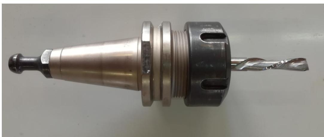
**Slika 51. Spiralno dvoperno glodalilo promjera 8mm**
