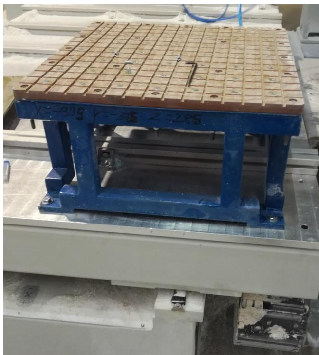
Slika 114. Prijenosni vakuum stol u poziciji za rad
