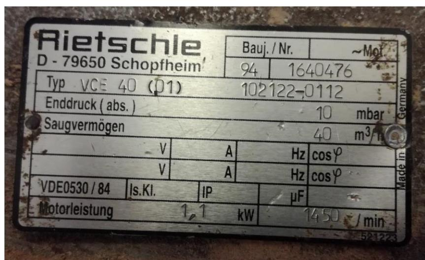
Slika 88. Pločica sa vakuum pumpe
