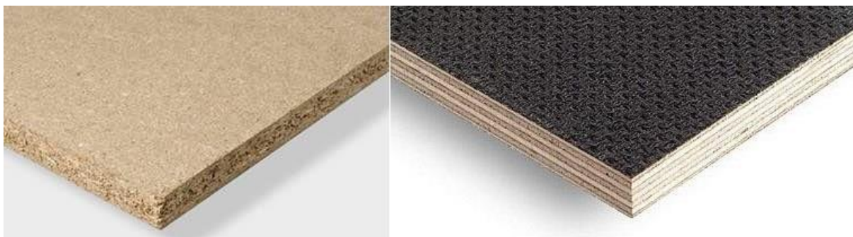
Slika 118. Iverica (lijevo), protuklizna šperploča (desno)
