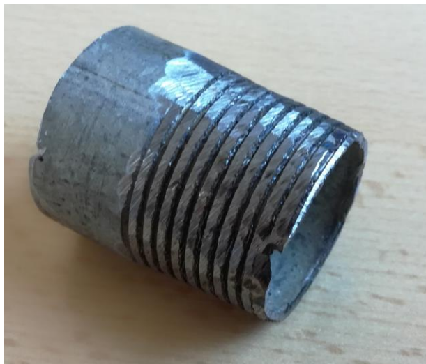
Slika 73. Komad cijevi spreman za zavarivanje na HV lim
