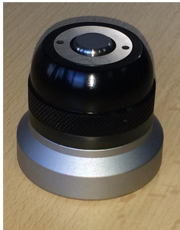
**Slika 105. Insize uređaj za umjeravanje alata**
