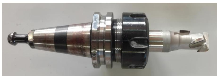
**Slika 47. Dijamantno glodalo promjera 20mm**
