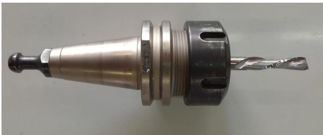
Slika 51. Spiralno dvoperno glodalo promjera 8mm
