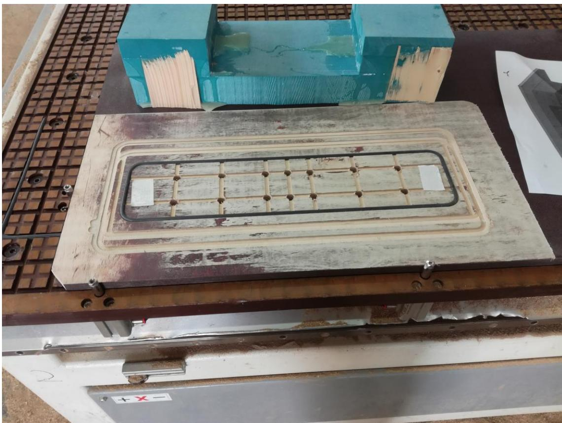
**Slika 119. Vakuumska šablonu od protuklizne šperploče**
