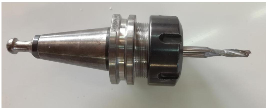
Slika 49. Spiralno dvoperno glodalo promjera 6mm
