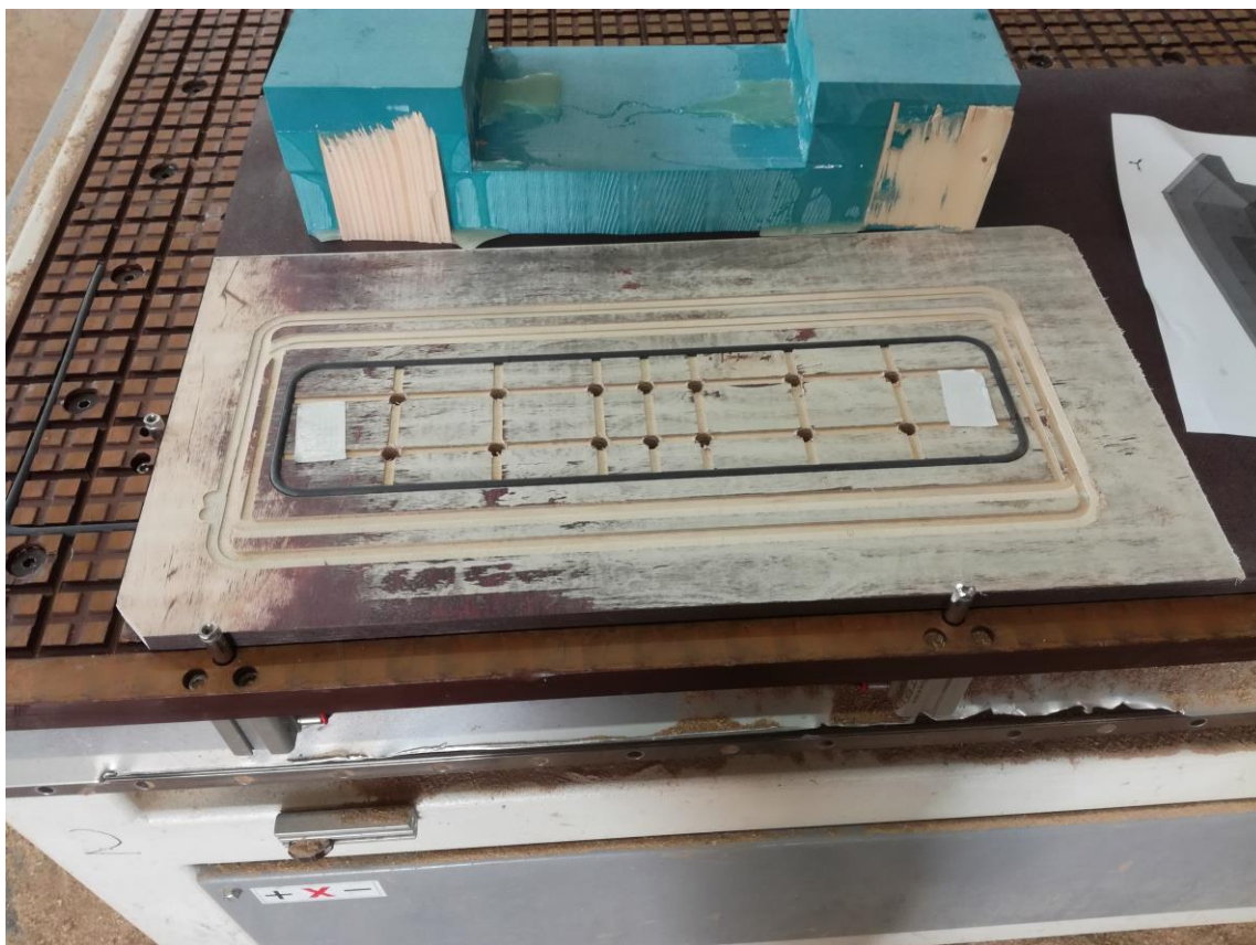
Slika 119. Vakuumska šablona od protuklizne šperploče
