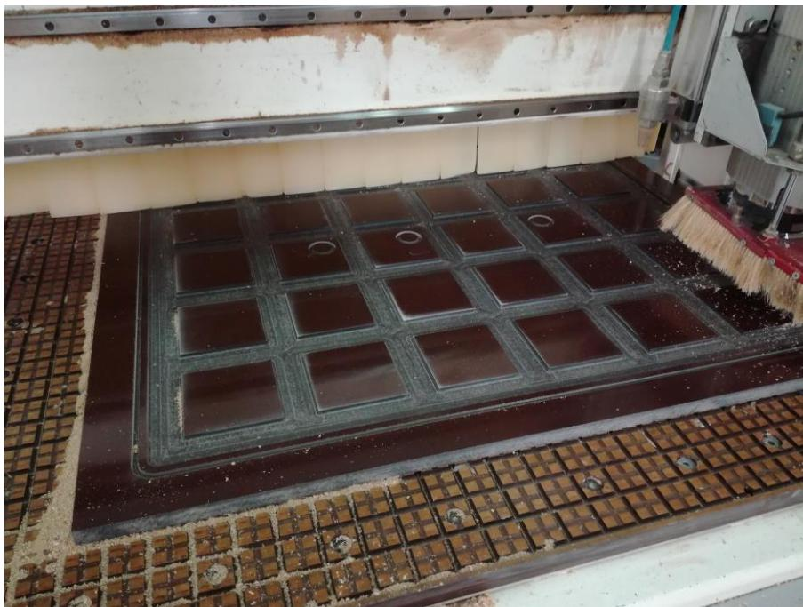
**Slika 59. Glodanje kanala za brtvu**
