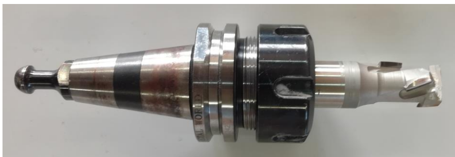
Slika 47. Dijamantno glodalo promjera 20mm
