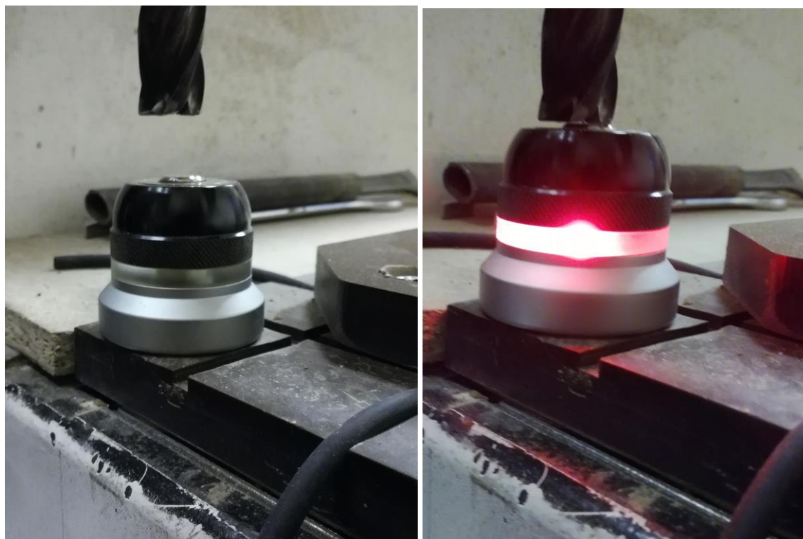
Slika 107. Alat prilikom umjeravanja
