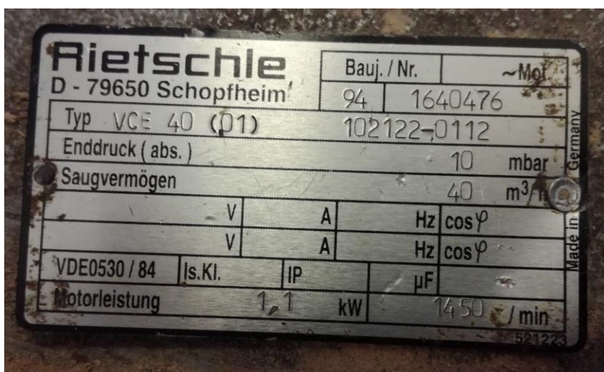
Slika 88. Pločica sa vakuum pumpe
