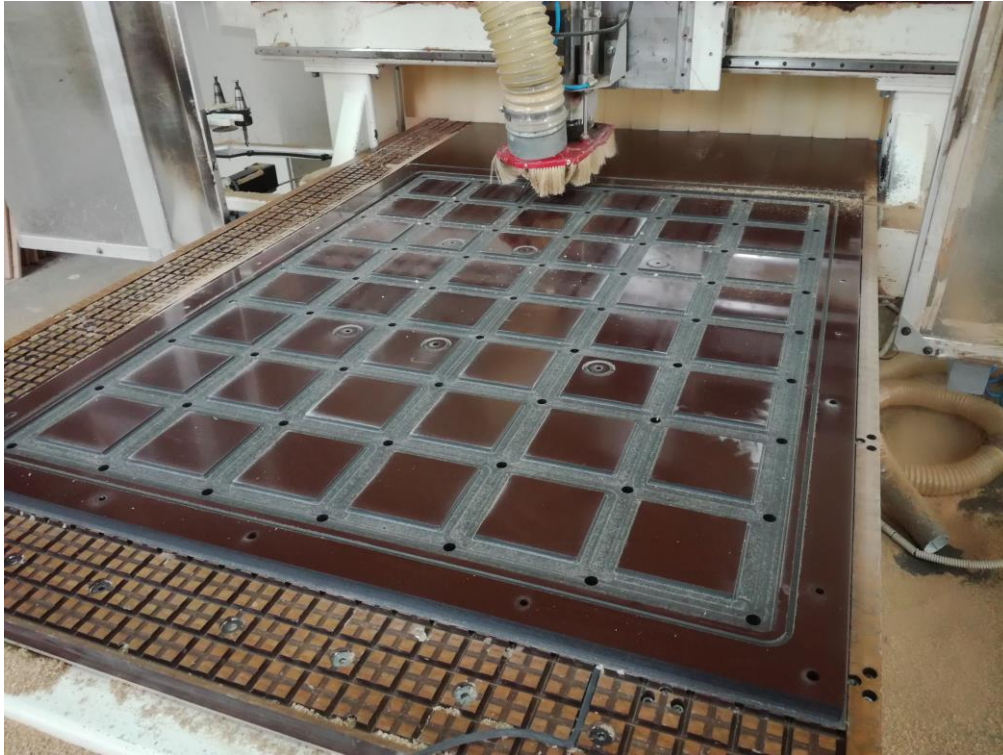
Slika 60. Bušenje rupa i vanjsko obrezivanje
