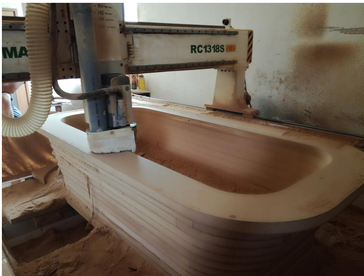
Slika 123. Glodanje velikih obradaka
