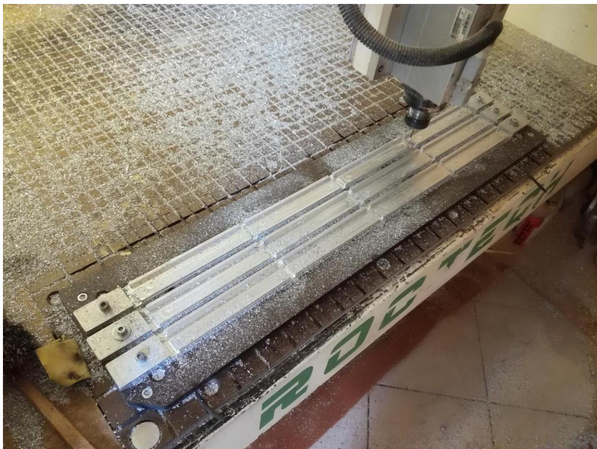
**Slika 140. Glodanje aluminijskih pločica**
