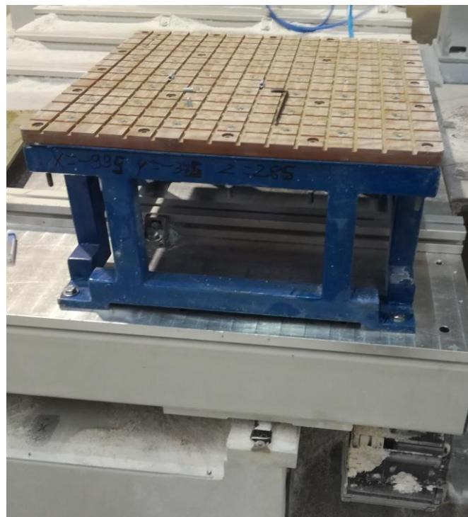
**Slika 114. Prijenosni vakuum stol u poziciji za rad**
