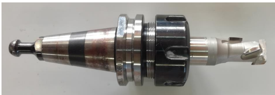
Slika 47. Dijamantno glodalo promjera 20mm
