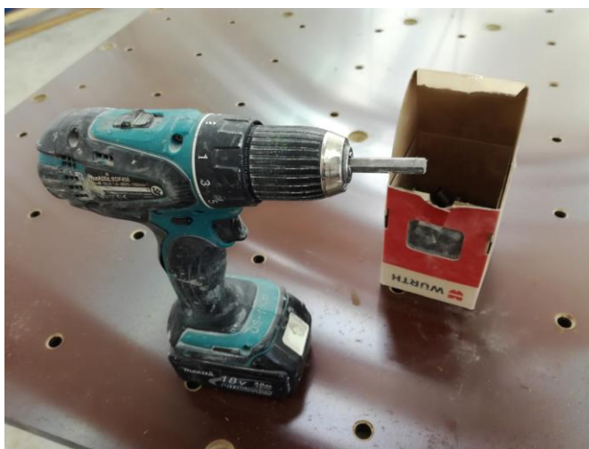
Slika 68. Akumulatorska bušilica sa imbus bitom
