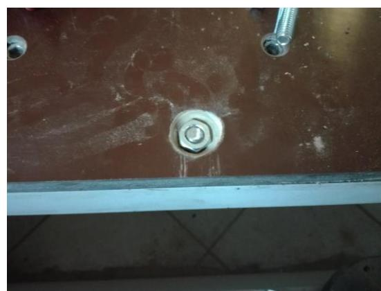
Slika 90. Improvizirani vijak M10x130 ugrađen u vakuum stol
