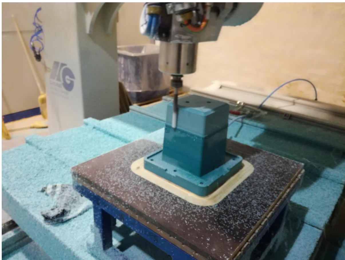
Slika 122. Glodanje necuron kalupa na prenosivom stolu
