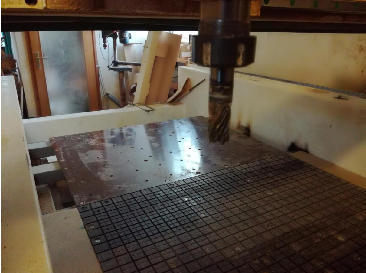
Slika 93. Druga polovica vakuum stola u konačnoj poziciji
