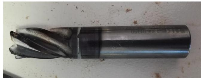
Slika 94. Tvrdometalno spiralno glodalo promjera 20mm
