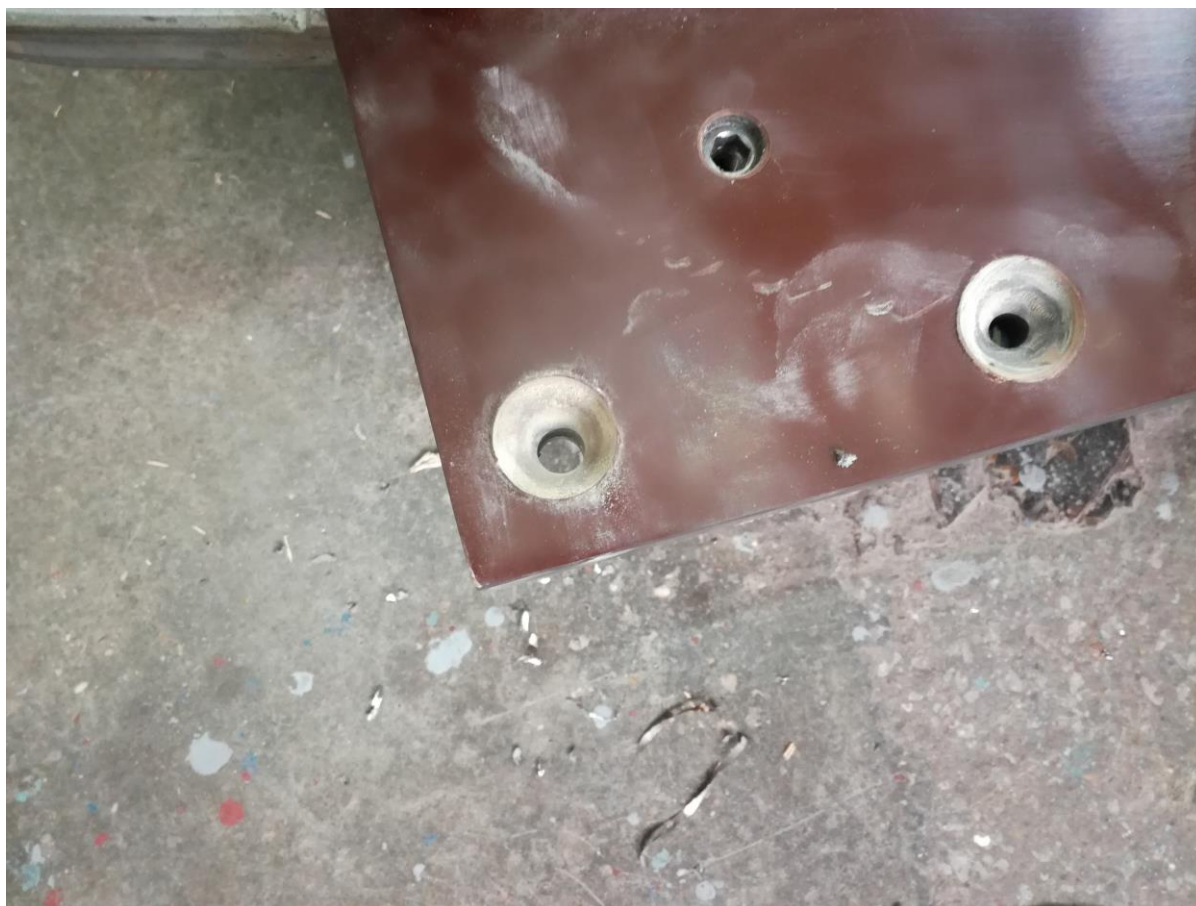
Slika 78. Izbušene rupe u HV limu kroz bakelit
