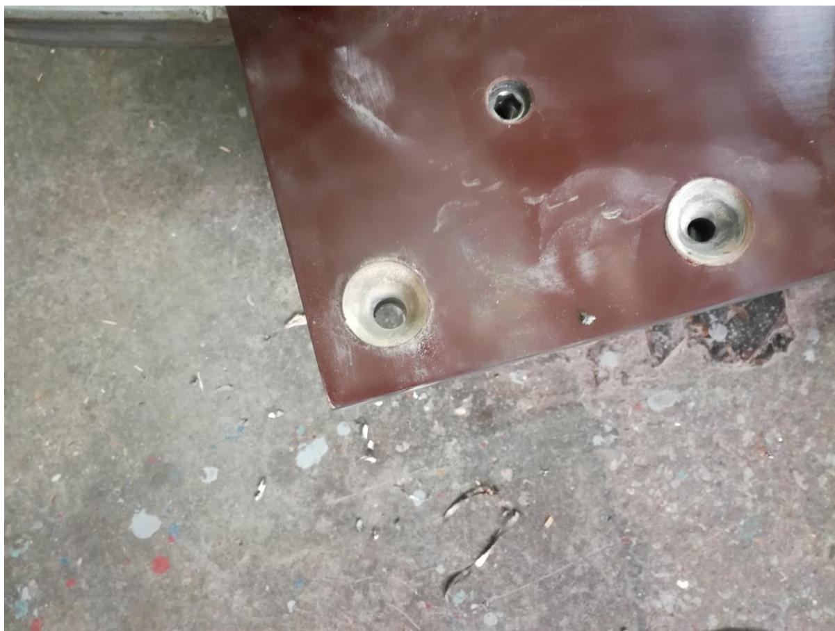
**Slika 78. Izbušene rupe u HV limu kroz bakelit**
