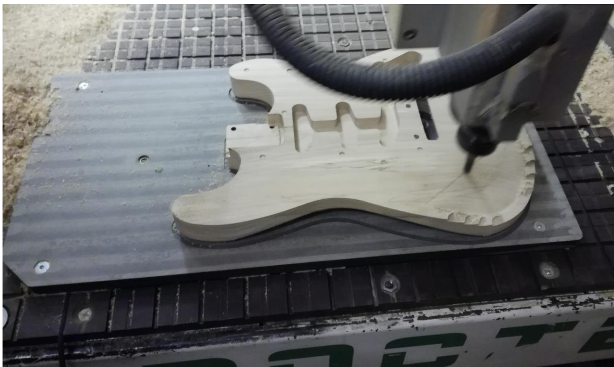
Slika 136. Glodanje druge strane tijela gitare
