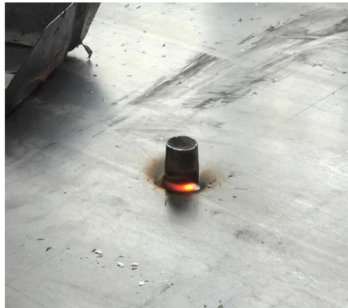
**Slika 75. Cijev u trenucima nakon zavarivanja**
