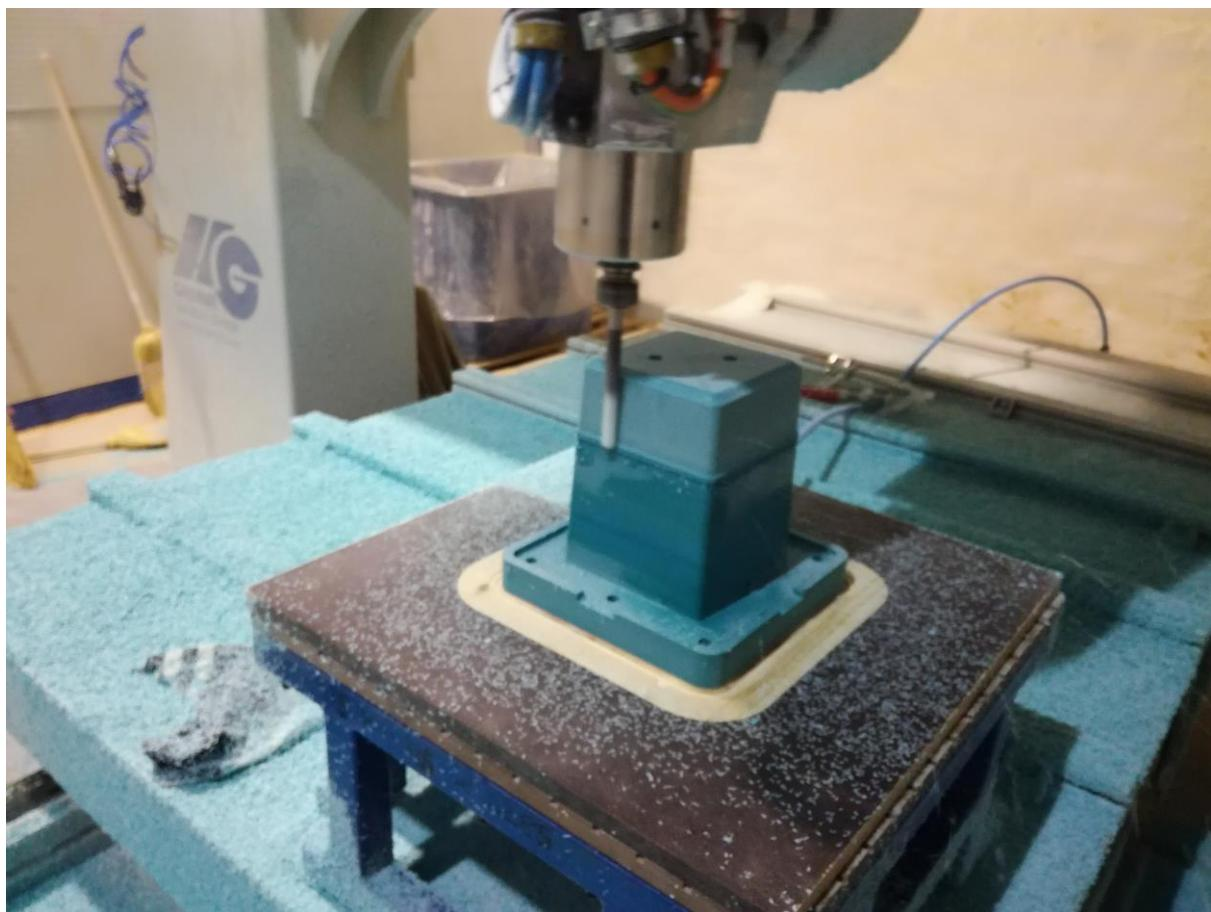
**Slika 122. Glodanje necuron kalupa na prenosivom stolu**
