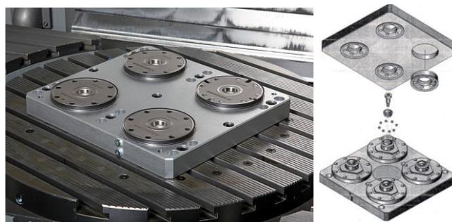
Slika 13. Stezni sustavi s definiranom nultočkom
