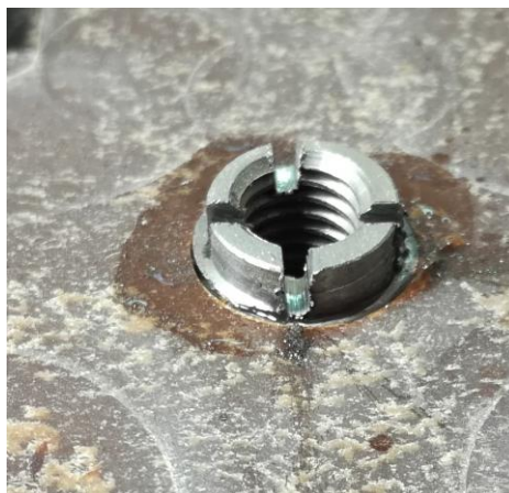
Slika 71. Zarezana i zalijepljena trio matica sa strane komore
