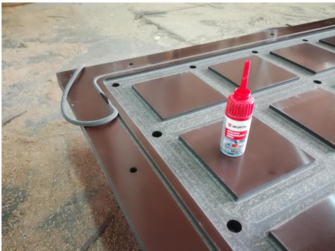
Slika 61. Lijepljenje gumene brtve u komoru vakuum stola
