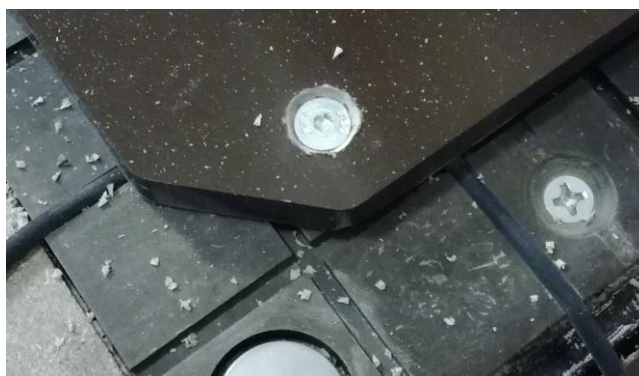
Slika 132. Skošena stezna rupa sa vijkom M8
