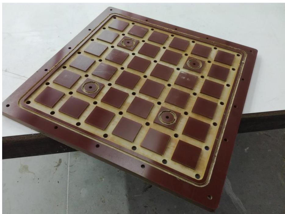
**Slika 108. Unutarnja komora malog vakuum stola**
