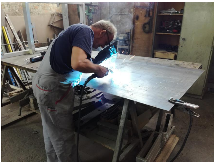
Slika 74. Majstor zavaruje cijev na HV lim
