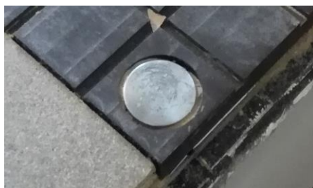
Slika 106. Metalni disk za umjeravanje alata
