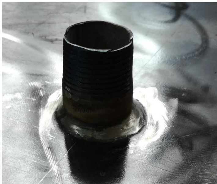
Slika 76. Konačni oblik zavara
