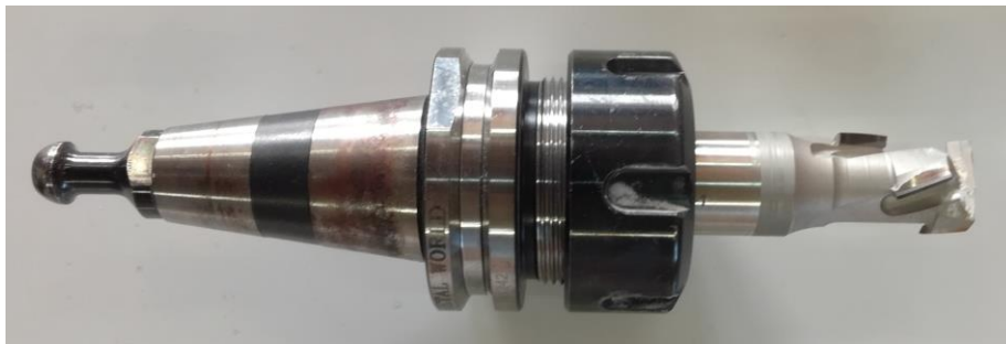
Slika 47. Dijamantno glodalo promjera 20mm
