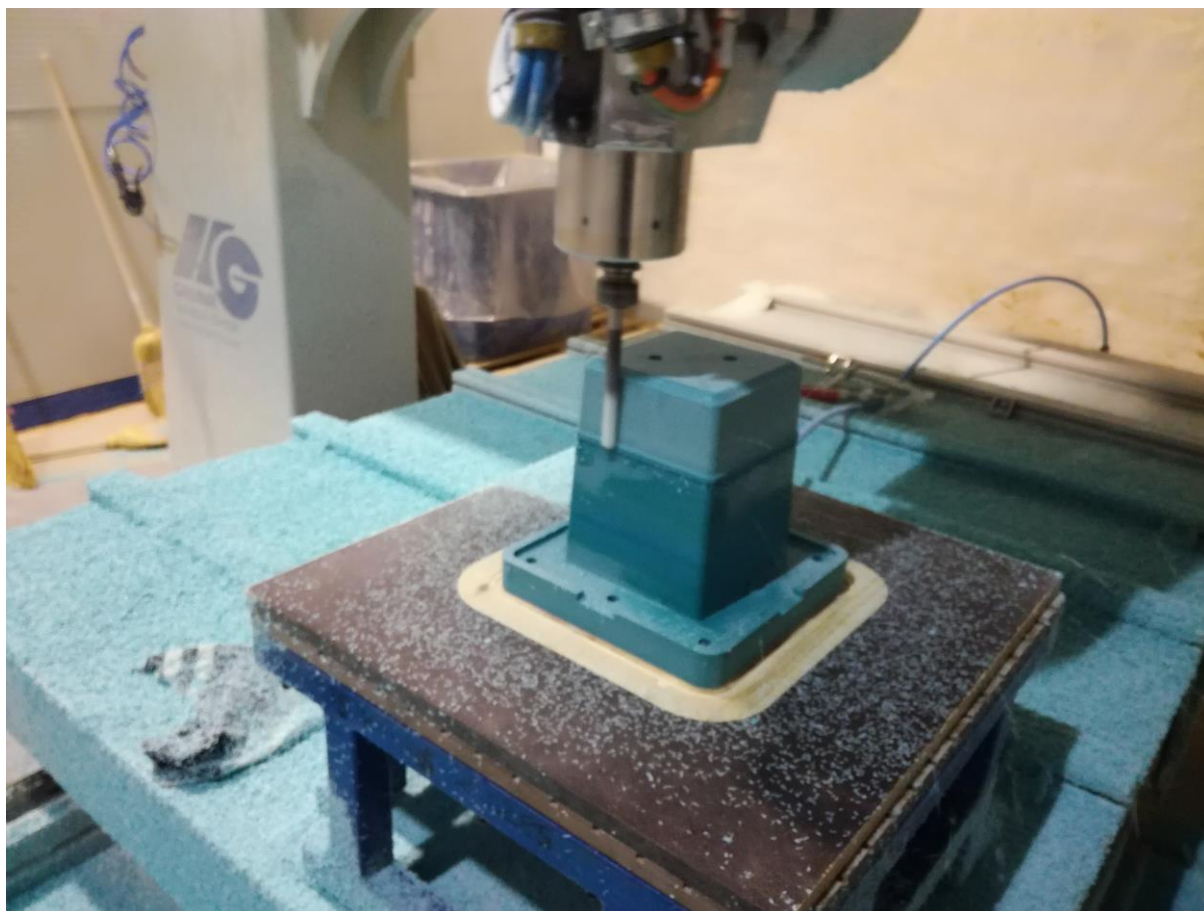
Slika 122. Glodanje necuron kalupa na prenosivom stolu
