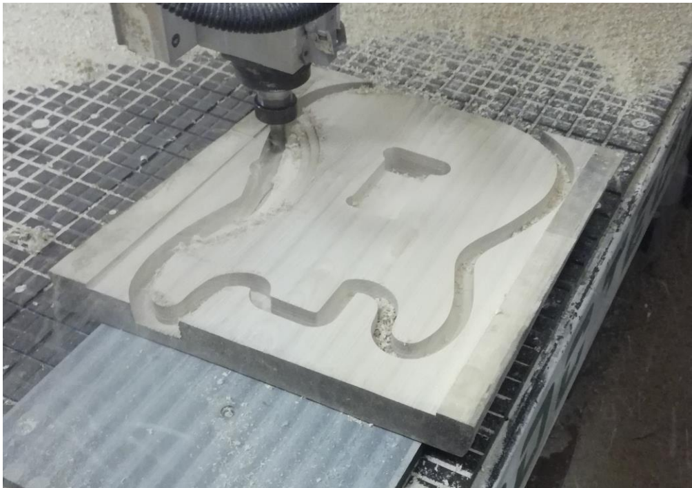
Slika 135. Glodanje prve strane tijela gitare
