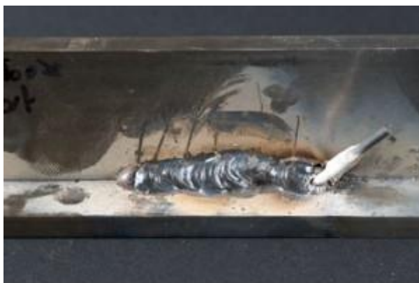
Slika 20. Kratka duljina električnog luka [2]
