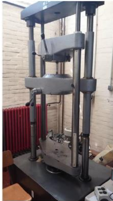
Slika 45. Predodžba kidalice WPM EU40mod [5]
