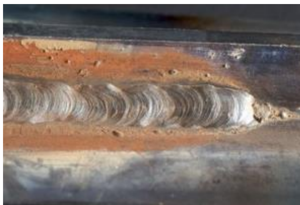
Slika 24. Prespora brzina zavarivanja [2]
