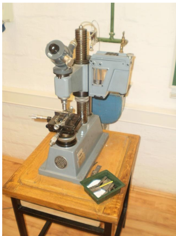
Slika 62. Predložba tvrdomjera Reicheter TM12 [28]
