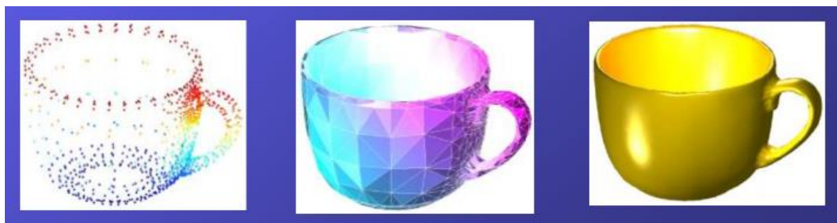
Slika 10. Poligonalni prikaz u izradi CAD modela
