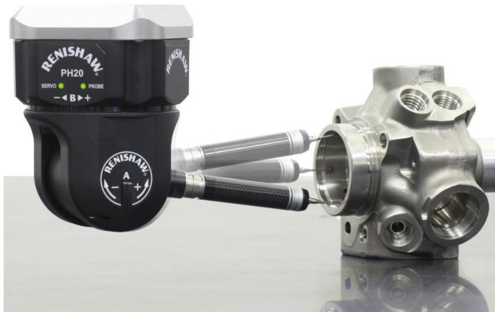
Slika 3. Mjerna glava Renishaw PH20 sa ticalom
