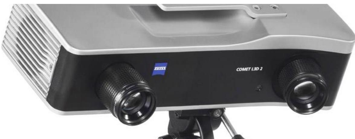
Slika 6. 3D digitalizator ZEISS COMET L3D 2
