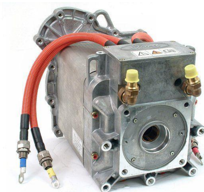
Slika 3. 3-phase AC motor za električni automobil [3]
