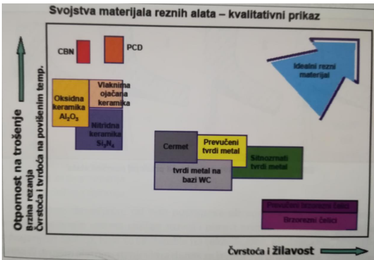
Slika 21 Podjela reznih materijala prema osnovnim svojstvima
