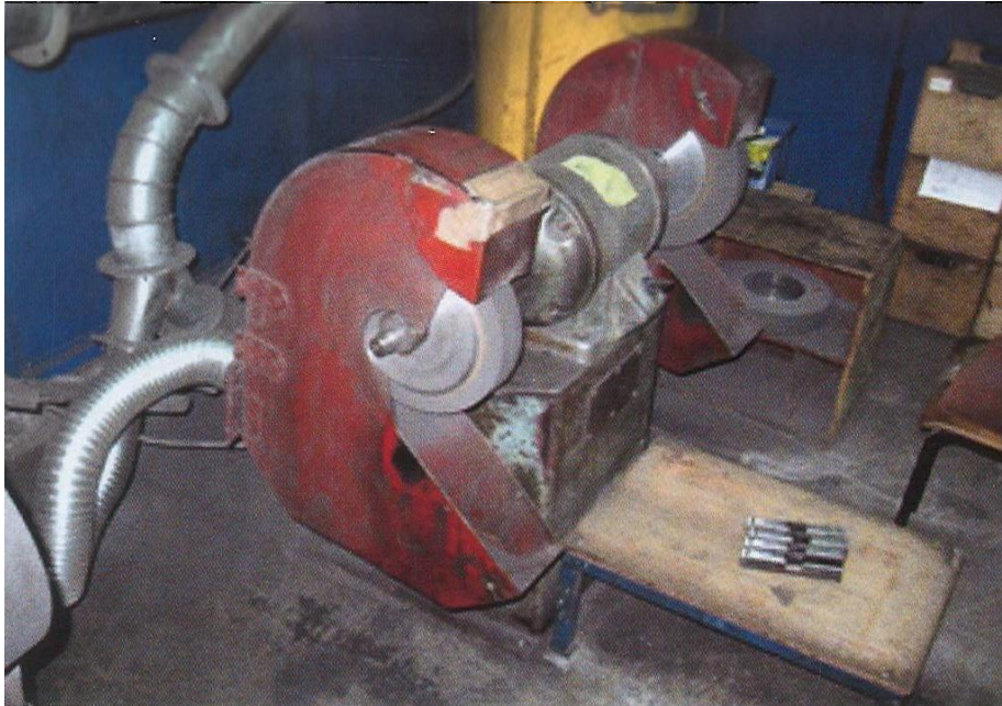
Slika 44 Stupna radionička brusilica nakon višegodišnje uporabe
