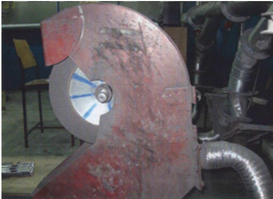
Slika 46 Izgled uređaja za odsisavanje prašine, izrađen u kombinaciji sa zaštitnim okloпом
