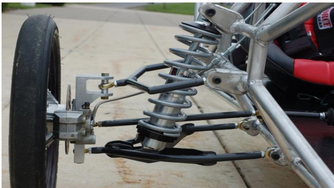
Slika 29. Ovjes fotonaponskog vozila
