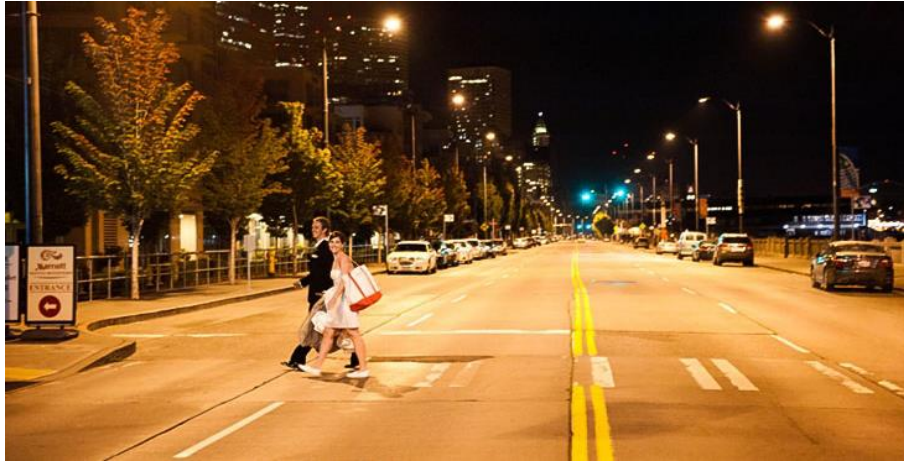
Slika 23. Primjer pješačkog prijelaza s osvjetljenjem na temelju negativnog kontrasta
