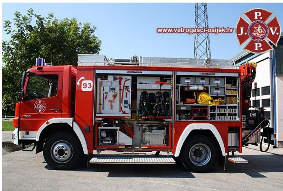
Slika 3. Tehničko vozilo teško za prijevoz 3 vatrogasca s potpunom opremom za sve vrste tehničkih intervencija u cestovnom prometu [5]
