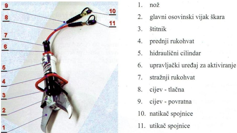
Slika 11. Osnovni dijelovi hidrauličnih škara [13]
