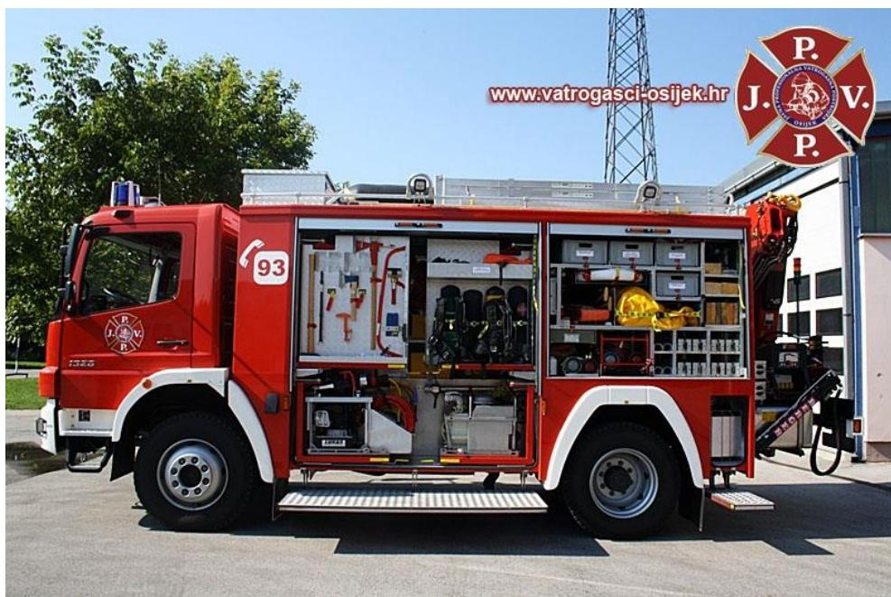
Slika 3. Tehničko vozilo teško za prijevoz 3 vatorgasca s potpunom opremom za sve vrste tehničkih intervencija u cestovnom prometu [5]
