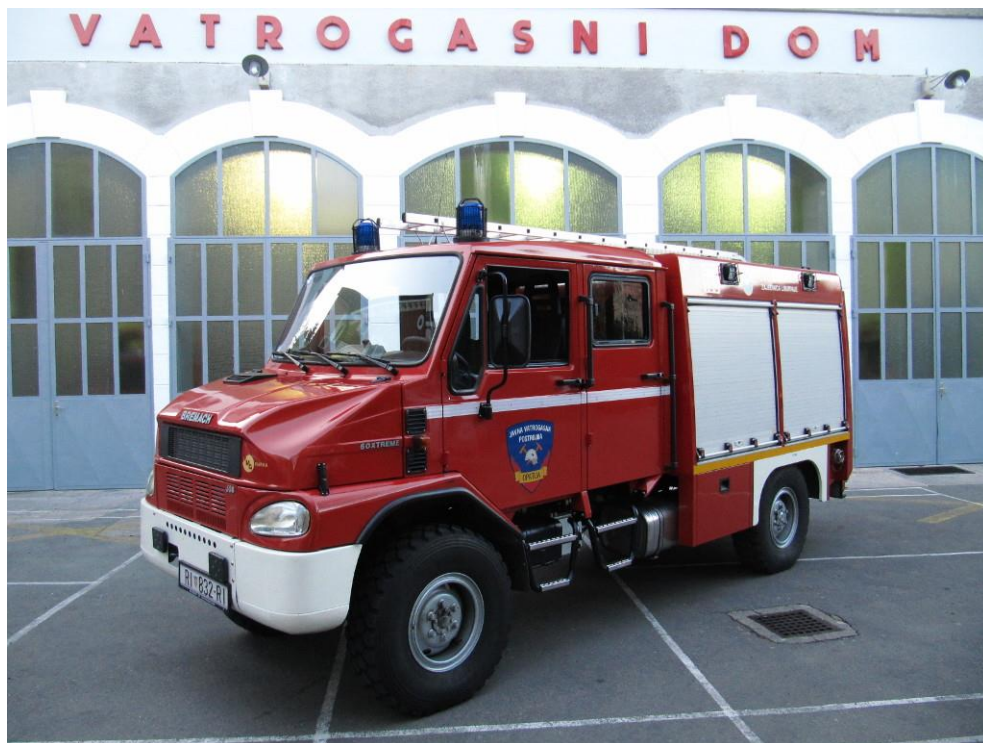
Slika 2. Tehničko vozilo srednje za prijevoz 6 vatrogasaca s hidrauličnim alatima za spašavanje [4]
