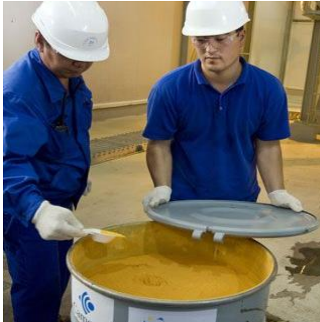
Sl. 15 Uranov koncentrat u standardnoj 200-litarskoj bačvi
