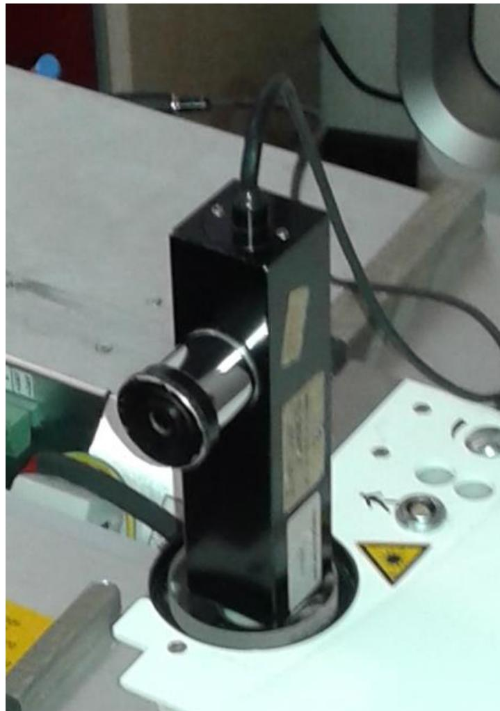
Slika 19. Predodba kolimatora i paralelnog stakla
