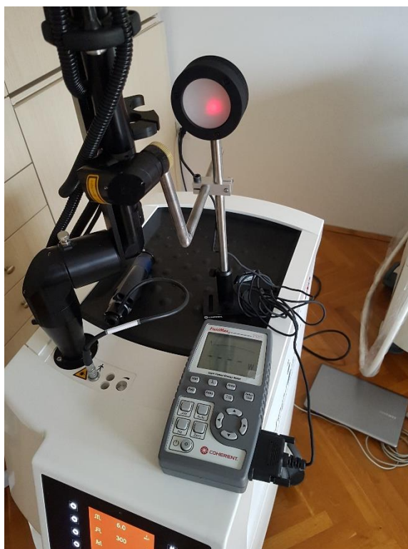
Slika 27. Predložba umjeravanja i mjerenja snaga
