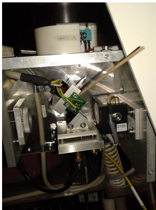
Slika 20. Predođba zaglavljenog zatvarača
