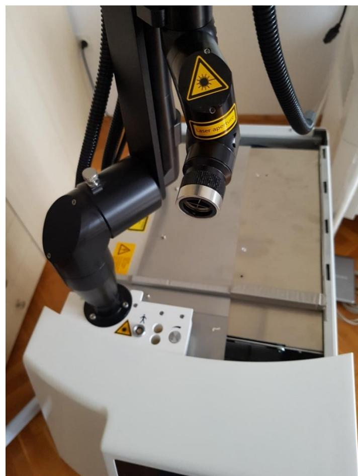
Slika 25. Predođba ciljnika montiranog na zglobnu ruku za testiranje sakupljača zrake
