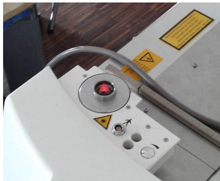
Slika 24. Predođba postolja za testiranje sakupljača zraka sa cilnjikom na izlazu iz lasera
