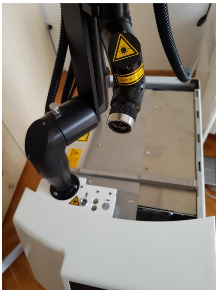
Slika 25. Predožba ciljnika montiranog na zglobnu ruku za testiranje sakupljača zrake
