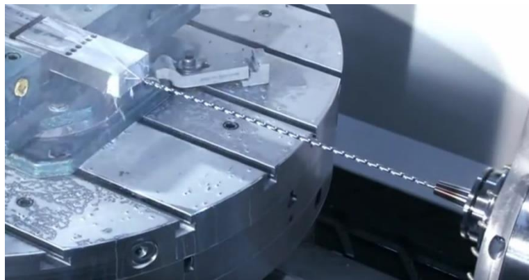
Slika 18. Duboko bušenje spiralnim svrdlom [10]
