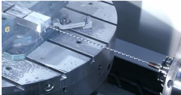
Slika 18. Duboko bušenje spiralnim svrdlom [10]
