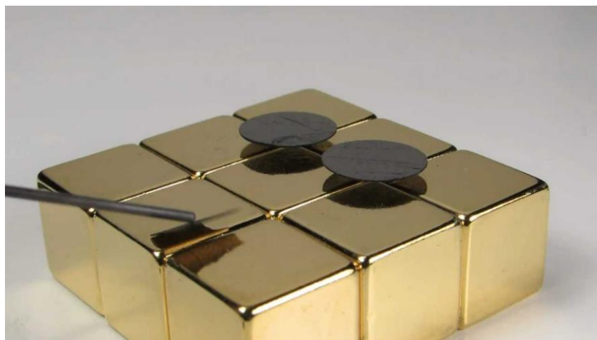
Slika 13. Prikaz dijamagnetizma pokusom
