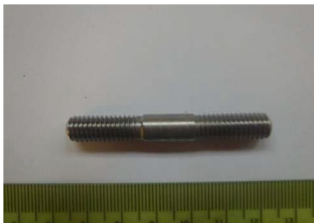
Slika 32. Implant uzorak s obostranim navojem[35]
