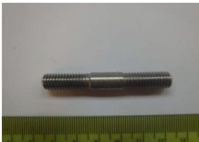
Slika 32. Implant uzorak s obostranim navojem[35]
