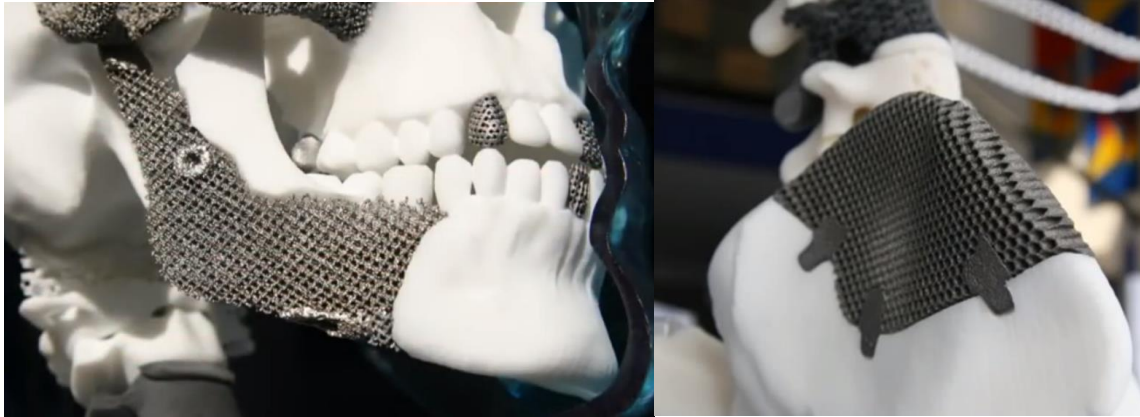
Slika 22. Primjena EBM-a u medicinskoj industriji za implantante [56]
