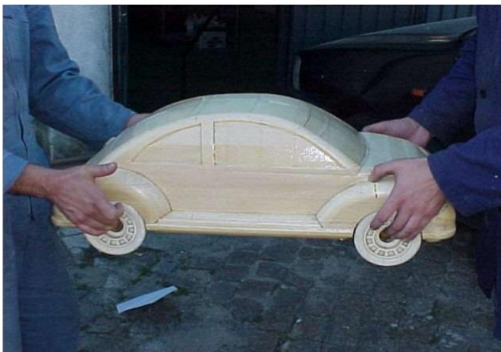
Slika 19. Model auta izrađen LOM tehnologijom [53]
