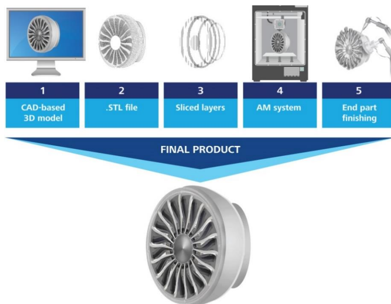
Slika 18. Faze izrade predmeta aditivnom tehnologijom. [34]
