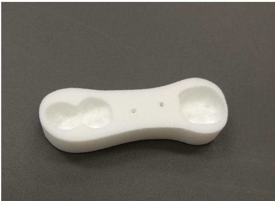
Slika 51. Izrađena vodilica 3D printanjem od materijala nylon.
