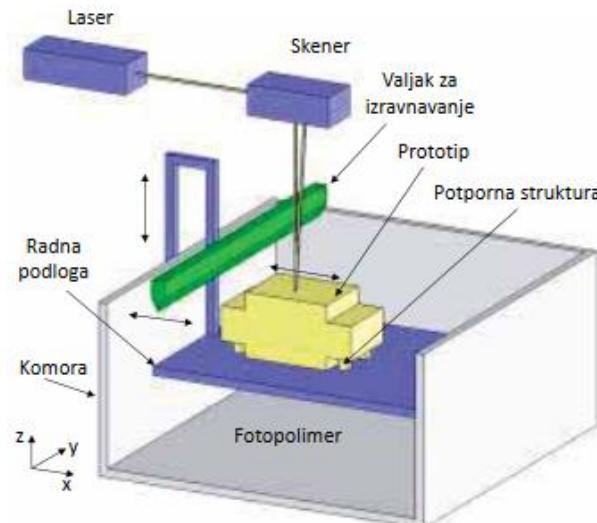
Slika 16. Postupak stereolitografije. [29]
