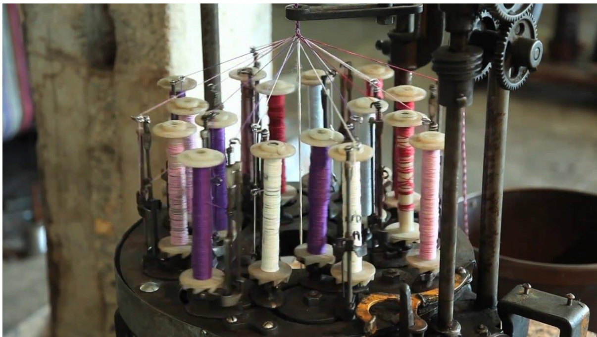
SLIKA 9. „MAYPOLE“ stroj za pletenje [9]
