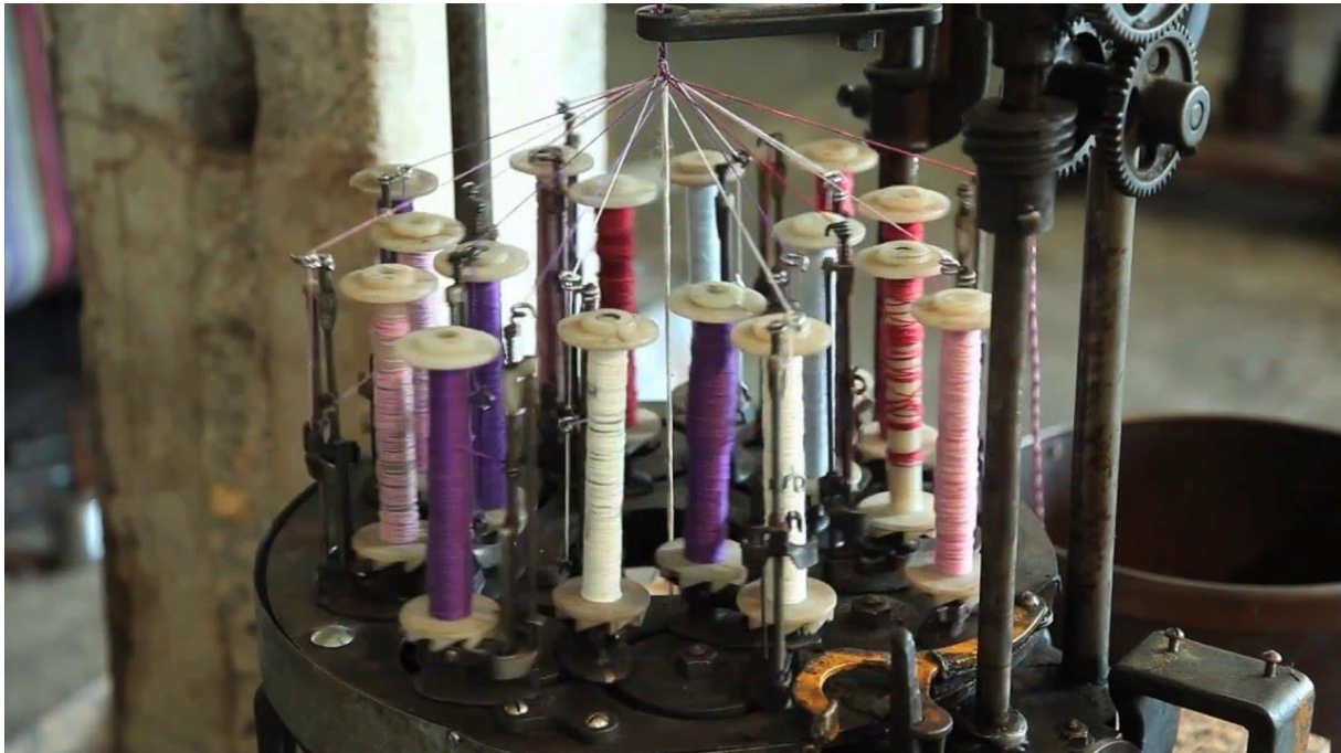
SLIKA 9. „MAYPOLE“ stroj za pletenje [9]
