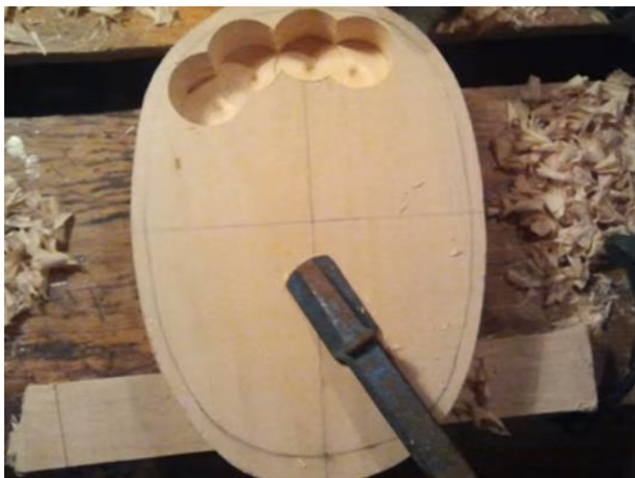
Slika 22. Izrada rezonantne kutije [13]
