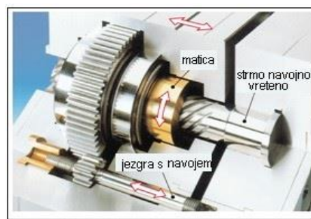
Slika 104: Navojno vreteno sa zupčanicima za okretanje i izvlačenje jezgre s navojem
