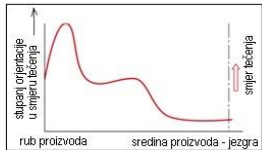
Slika 51: Prikaz stupnja orijentacije molekula na rubu i sredini proizvoda-štap
