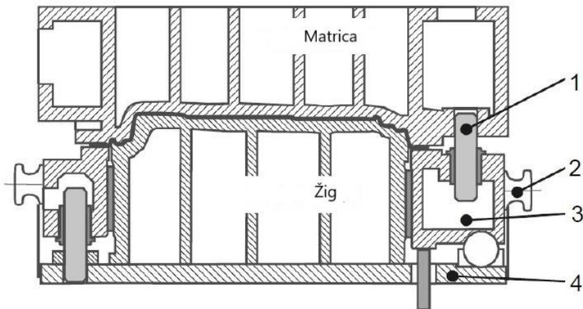
**Slika 3.10 Klasična izvedba jednoradnog alata za vučenje**
