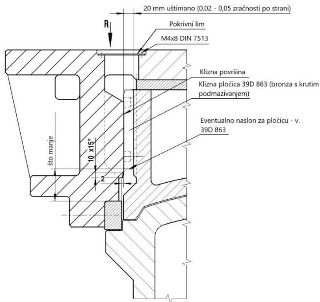
**Slika 3.45 Vođenje pritiskivača kliznim pločama [13]**
