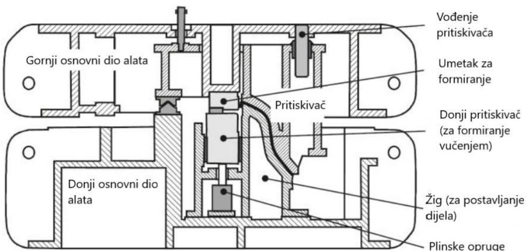
**Slika 3.72 Presjek kombiniranog alata s formiranjem u Z-smjeru**
