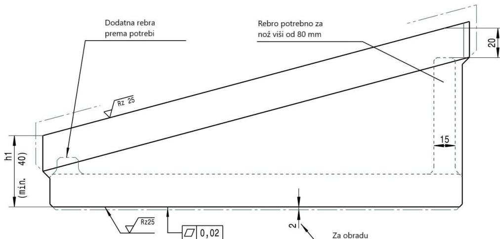
Slika 3.31 Tlocrt lijevanog noža [8]
