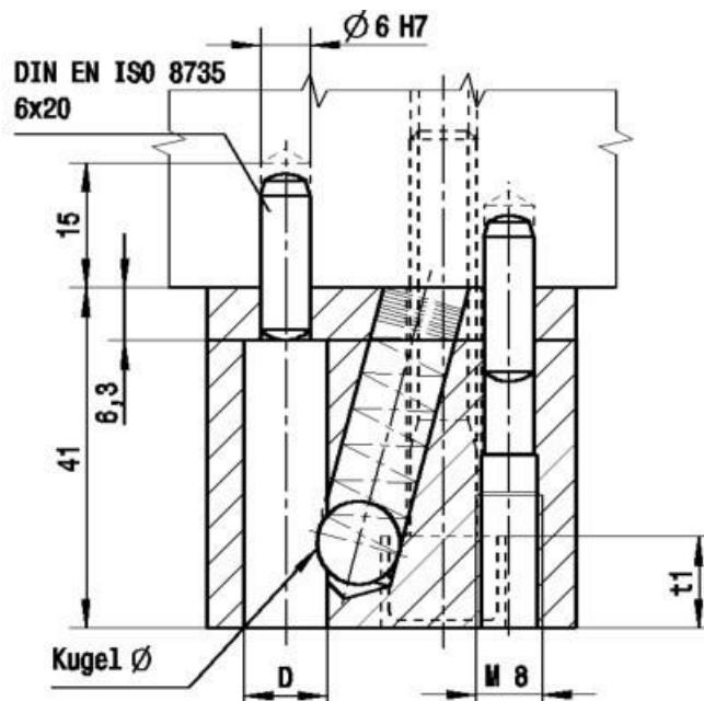
Slika 3.37 Presjek prihvratne pločice sa osiguranjem pomoću kuglice [10]
