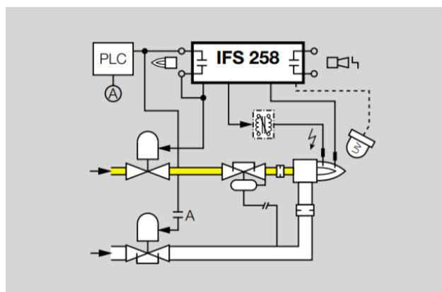
Slika 8 Shematski način spajanja IFS258 ( [www.combustion911.com](http://www.combustion911.com) )
