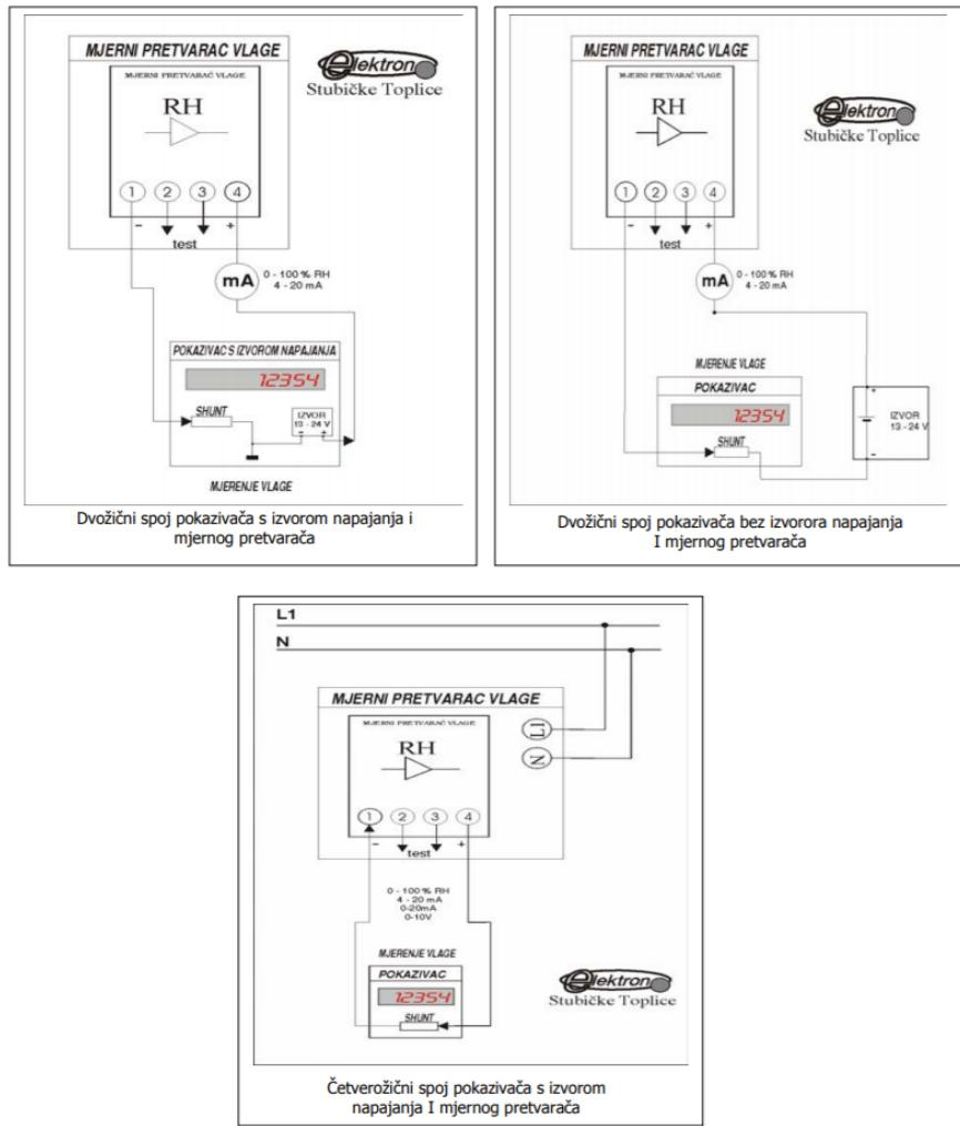
Slika 4 Primjeri spajanja mjernog uređaja za temperaturu i vlagu ([www.elektron.hr](http://www.elektron.hr))
