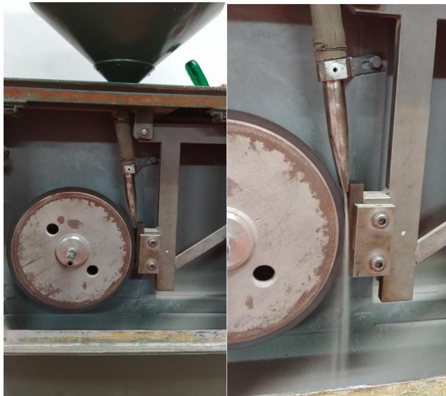
**Slika 10.4.** Izvođenje pokusa na uređaju za suhu abraziju
