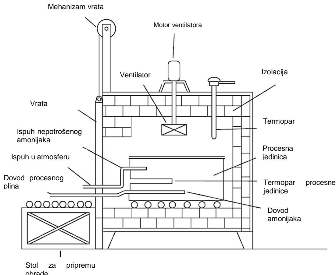
**Slika 1.2. Shematski prikaz jednostavne peći za nitriranje.**
