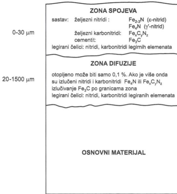
**Slika 3.1.** Shematski prikaz površinskog sloja dobivenog nitriranjem [5]
