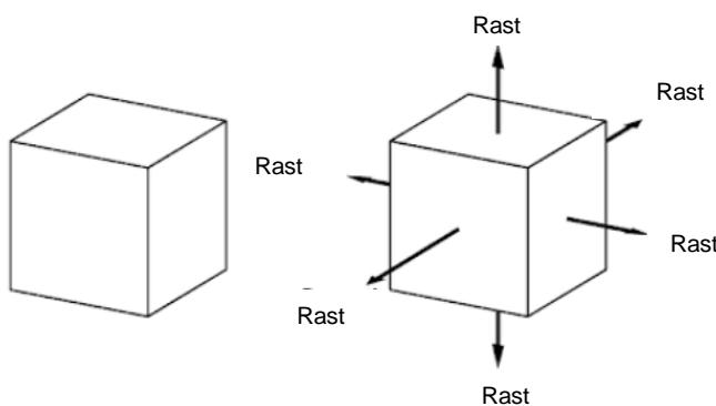
**Slika 2.3. Ilustracija rasta volumena uslijed nitriranja. Veličina promjene je određena vremenom provedenim na zadanoj temperaturi procesa**
