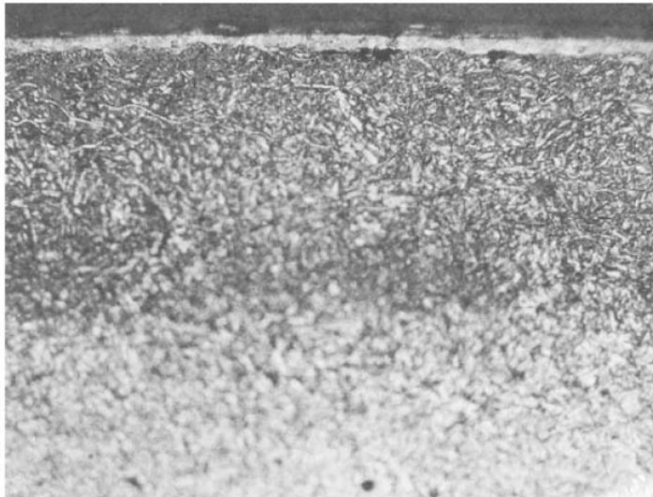
Slika 3.2. Tipična struktura nitriranog obratka gdje se vidi na vrhu zona spojeva (bijeli sloj), zona difuzije i osnovni materijal [2]
