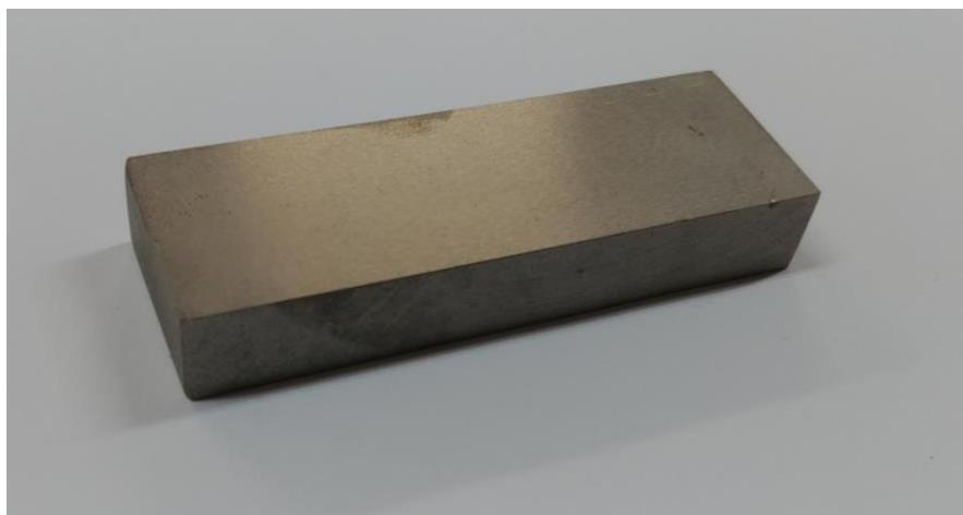
**Slika 10.1.** Epruveta nakon nitriranja i prije ispitivanja abrazije
