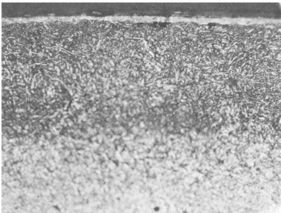
**Slika 3.2.** Tipična struktura nitriranog obratka gdje se vidi na vrhu zona spojeva (bijeli sloj), zona difuzije i osnovni materijal [2]
