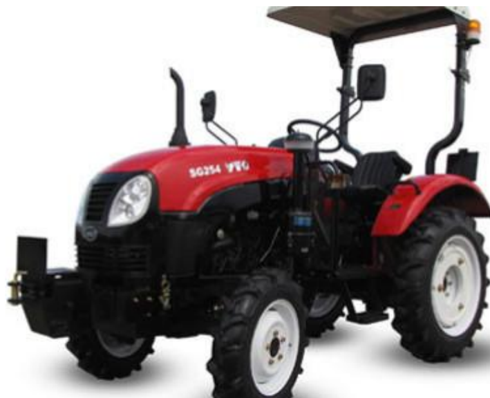
Sl. 8. Traktor sa zaštitnim okvirom [15]
