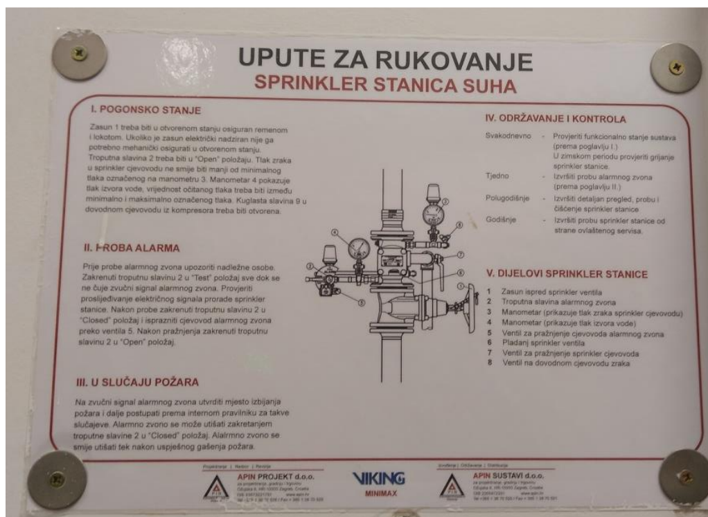
Slika 41. Uputa za rukovanje sprinkler sustavom – suhi [10]
