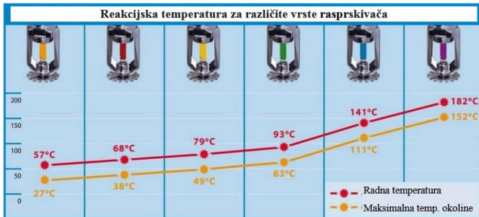
Slika 36. Sprinkler mlaznice sa staklenom ampulom [24]
