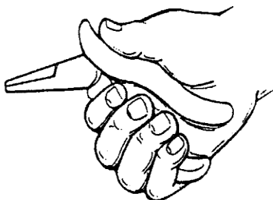
Slika 14. Korištenje kliješta koja su prilagođena ruci
