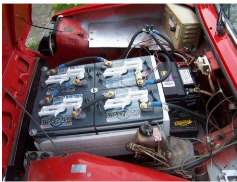
Slika 17. Olovna baterija za elektroauto
