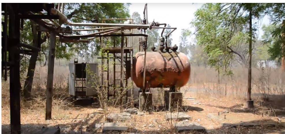
Slika 35. Neuklonjeni spremnik Fozgen-a [21.]
