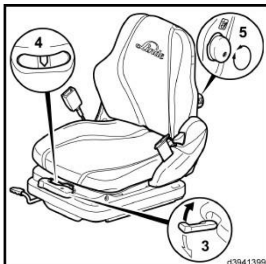
Sl. 30. Mogućnosti namještanja sjedala Linde H25D [8]
