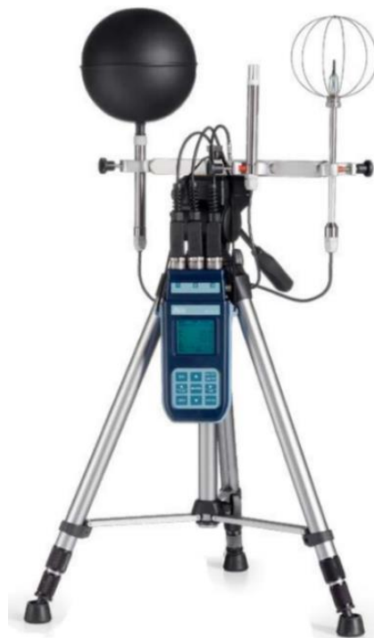
Sl. 6. DeltaOhm HD 32.3, uređaj za analizu WBGT - PMV – PPD [8]
