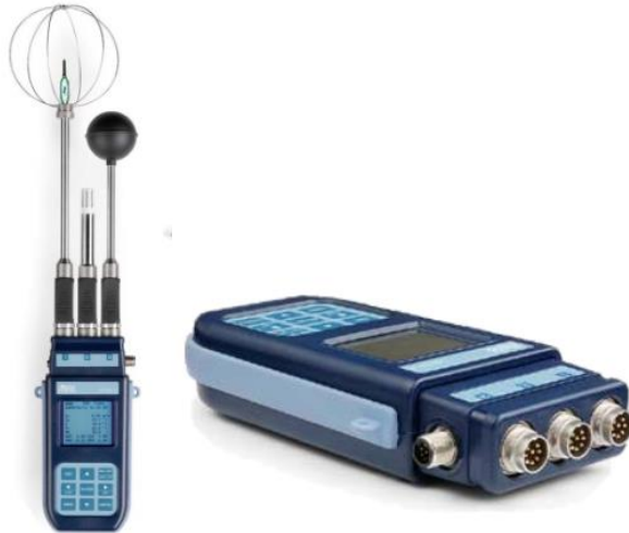
Sl. 7. DeltaOhm HD 32.3, uređaj za analizu WBGT - PMV – PPD [8]
