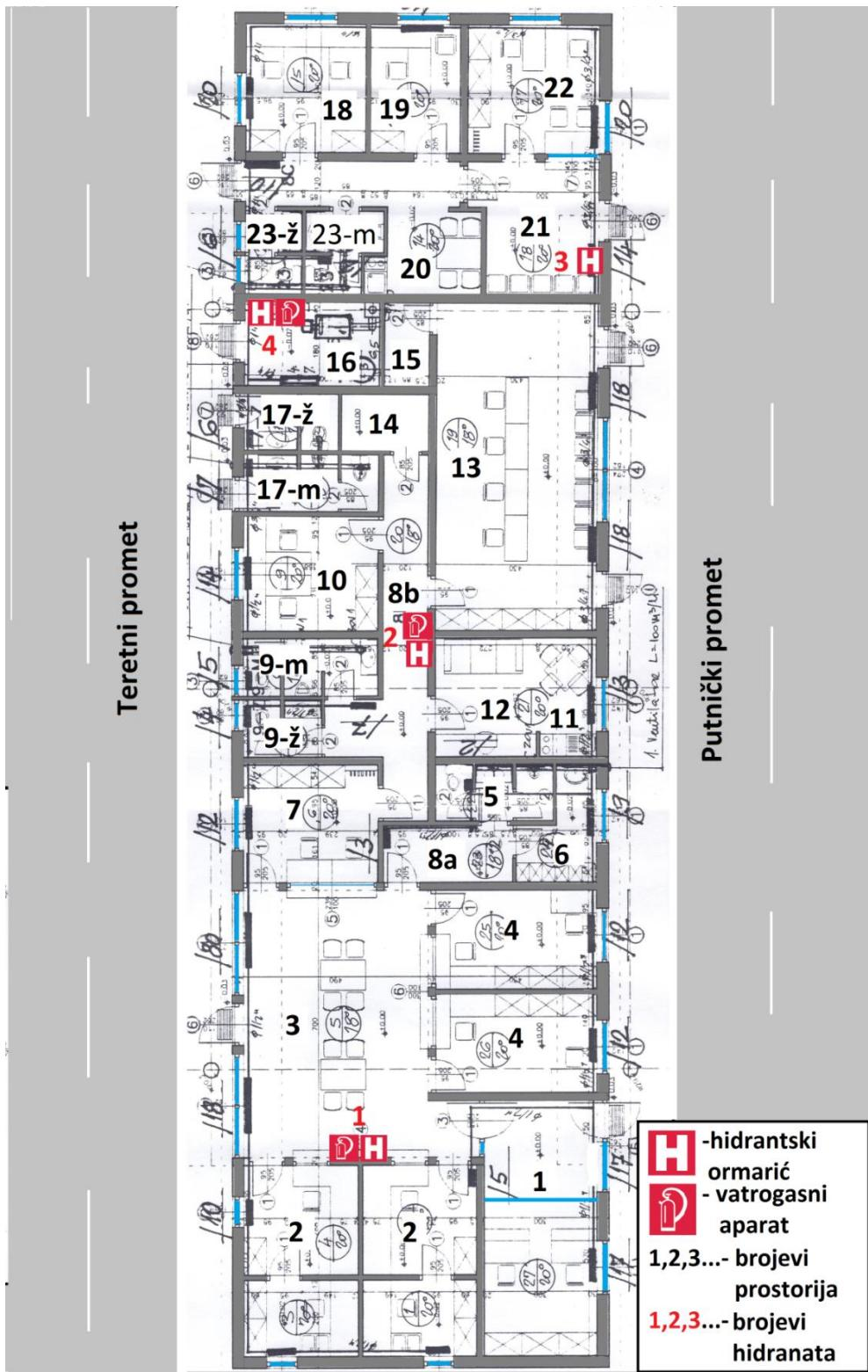
Slika 25. Tlocrt zgrade MCGP Maljevac sa rasporedom hidrantskih ormarica
