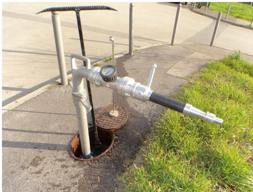
Slika 15. Ispitivanje hidrantske mreže (mjerjenje tlaka i protoka vode) [18]
