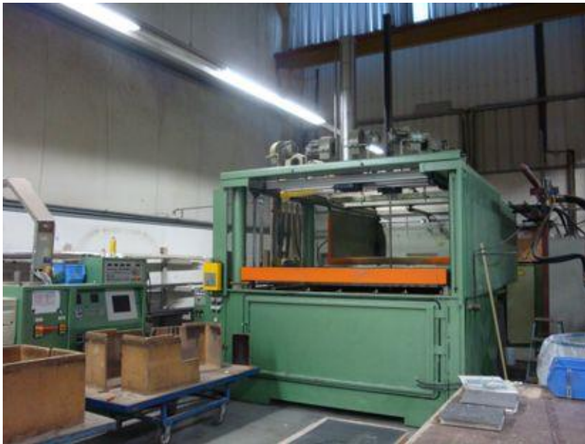
Slika 15: Automatski stroj za termo formiranje
