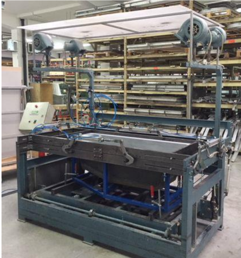
Slika 14: Polu automatski stroj za termo formiranje
