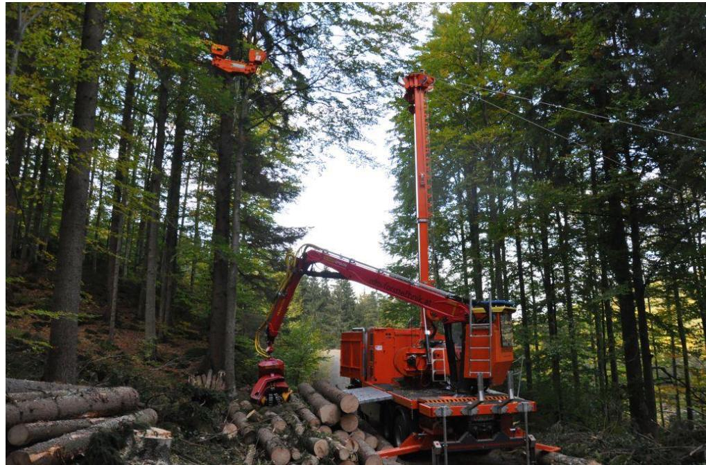
Slika 4: Vučena šumska žičara s vlastitim pogonskim uređajem na priključnom vozilu
