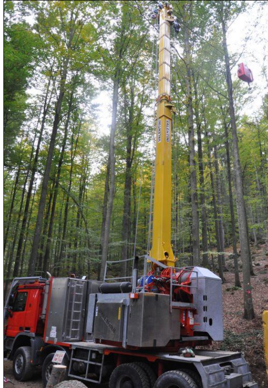
Slika 3: Šumska žičara s vlastitim pogonskim uređajem postavljenim na kamion ( https://holz.fordaq.com/fordaq/news/Austrofoma_Seilkran_Koller_Konrad_Mayr_Melnhof_44312.html )
