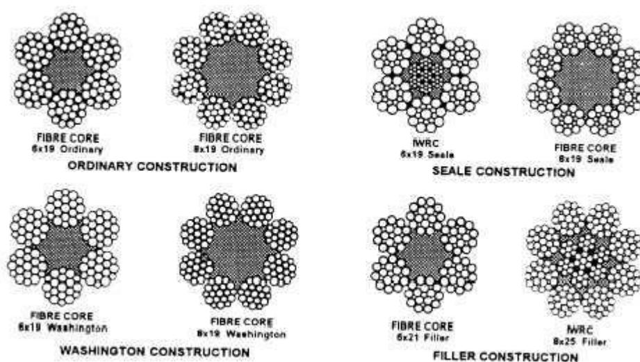
Slika 7: Konstrukcija čelične užadi SEAL i FILLER
